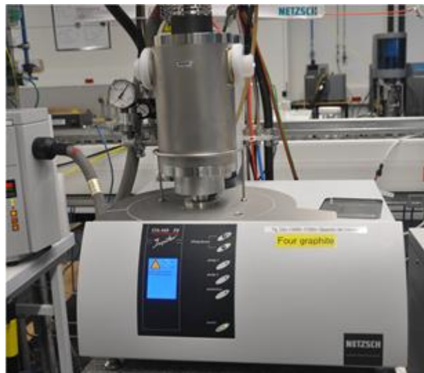
Figure 32 : Appareil utilisé pour l'analyse thermogravimétrique (TGA NETZSCH STA 449 F3 Jupiter)
