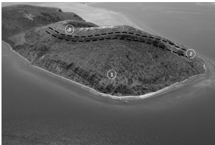
Figure I-24 : Vue aérienne de l'île Uitoé, dans la Baie de Saint-Vincent. Les Calcaires de Uitoé (2) reposent en discordance sur le socle sédimentaire (1 : Teremba terrane ) ; (3) turbidites fines volcanoclastiques ; (Maurizot 2014)
