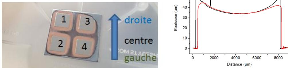
Figure 3.51 : (a) Photographie du substrat après une étape de polissage (b) Mesure au profilomètre mécanique Dektak 8 des motifs en FeNi.
