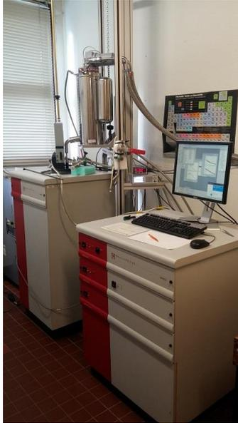
*Figure 1.19 : Présentation d'un magnétomètre à SQUID (<https://iscr.univ-rennes1.fr/prts/magnetometre-a-squid-mpms>).*
