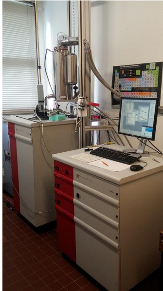
Figure 1.19 : Présentation d'un magnétomètre à SQUID ( https://iscr.univ-rennes1.fr/prts/magnetometre-a-squid-mpms ).
