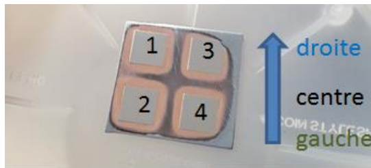
Figure 3.51 : (a) Photographie du substrat après une étape de polissage (b) Mesure au profilomètre mécanique Dektak 8 des motifs en FeNi.
