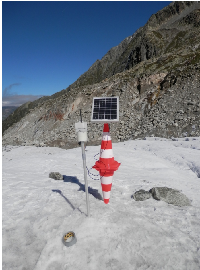
FIGURE 2.10 – Installation d'un Géocube sur le glacier d'Argentière
