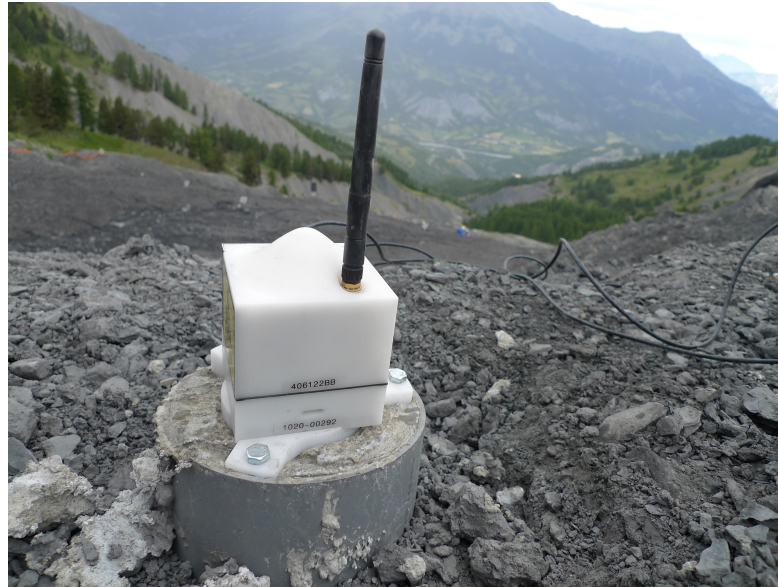
FIGURE 2.9 – Déploiement d'un Géocube sur le glissement de terrain Super-Sauze
