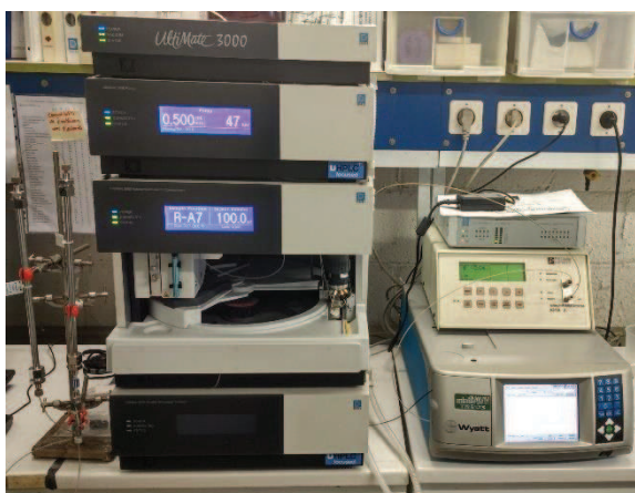
Figure 21. Système analytique de détermination des masses molaires par chromatographie d'exclusion stérique avec une double détection par réfractométrie différentielle et diffusion de la lumière et de la polydis (HPSEC-MALLS-dRI).
