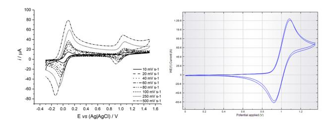
**Figure R3** - Voltamogramme cycliques de DCMF 1:1 et de macrocycle **7**, enregistré à différentes vitesses de balayage, dans une solution de 10<sup>-1</sup> M TBAPF<sub>6</sub> dans du DCM sec (gauche) et voltamogramme cyclique de macrocycle **15** dans une solution de 10<sup>-2</sup> M TBAPF<sub>6</sub> dans du THF dégazé et sec à une vitesse de balayage = 100 mVs<sup>-1</sup> (droite).
