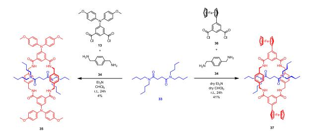
**Figure R10** - Schéma de synthèse des [2]rotaxanes **35** et **37** obtenus par une fermeture de la molécule macrocyclique.
