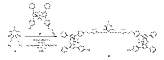
Figure R7 - Schéma de synthèse de fil d'azadipyrrométhène-chélate de BF<sub>2</sub> 25.
