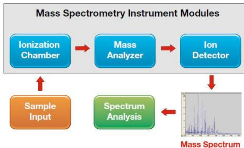
Figure 2.01: principe d'une analyse par spectrométrie de masse
