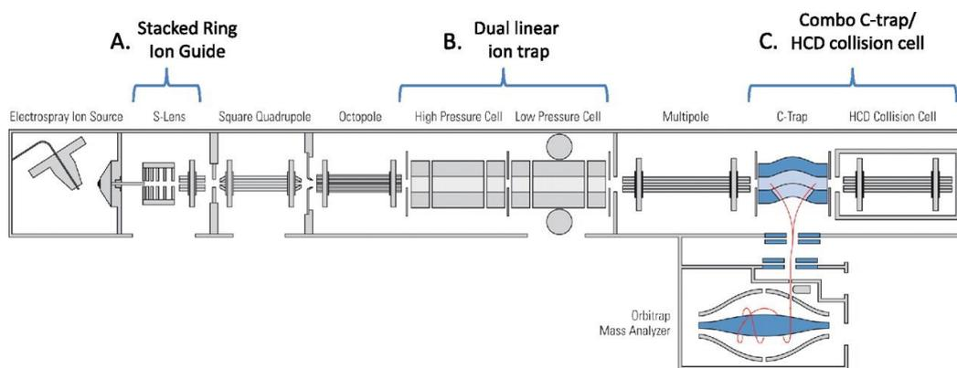
Figure 2.04 : Schéma représentatif de LTQ-Orbitrap Velos Pro.
