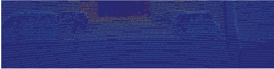
FIGURE 6.2 – Un exemple de scan LiDAR artificiellement densifié où les pixels non observés par le LiDAR ont été encodés avec des 0. La colormap va de 0 mètre (en bleu) à 80 mètres (en rouge)
