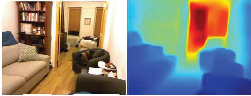
FIGURE 4.1 – Exemple d’inférence de profondeur monoculaire au niveau de l’état de l’art, entraînée avec un CNN multiéchelles.
