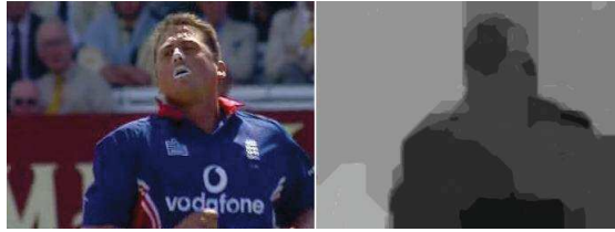
FIGURE 2.6 – Un exemple d'estimation de profondeur monoculaire à partir d'indices de flou résultant du defocus de la caméra (Zhuo et Sim, 2009)
