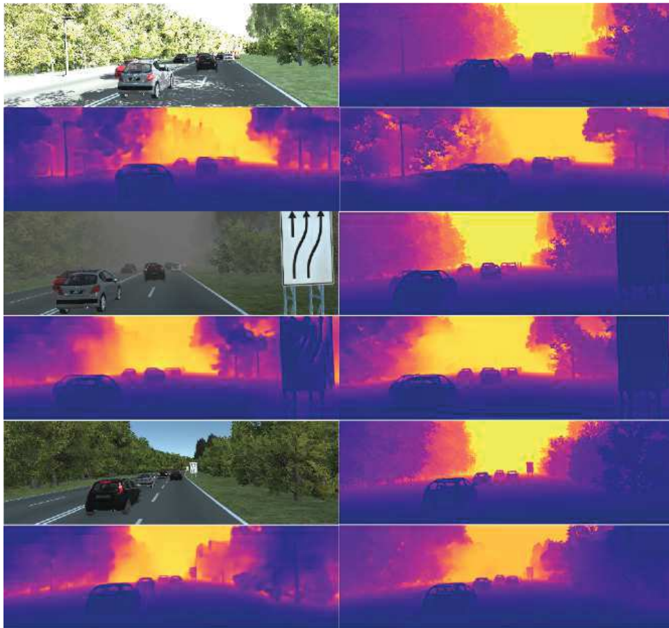
FIGURE 7.10 – Illustration des résultats de notre meilleur modèle sur Virtual KITTI. Pour chaque image de test on trouve : en haut à gauche une des images RGB donnée en entrée ; en haut à droite la vérité terrain de profondeur plafonnée à 80m ; en bas à gauche la prédiction par le réseau de Laina et al. (2016) ; en bas à droite la prédiction de notre modèle
