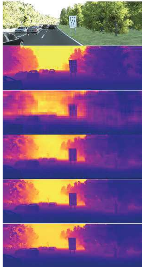
FIGURE 7.9 – Illustration de l’approche multi-échelle sur Virtual KITTI. De haut en bas on trouve : une des images d’entrée, la vérité terrain puis les quatre prédictions de profondeur, de la résolution la plus faible à la plus élevée.
