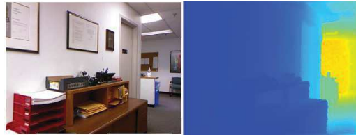
FIGURE 3.2 – Une image de test de NYU Depth v2. À gauche l’image \mathcal{RGB} (entrée) et à droite la carte de profondeur \mathcal{D} associée (sortie attendue)
