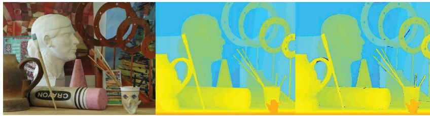
FIGURE 2.4 – Un exemple d'estimation de profondeur utilisant la stéréovision, par Hadfield et Bowden (2015). L'image d'entrée à gauche, leur estimation de profondeur au milieu et la vérité terrain à droite.
