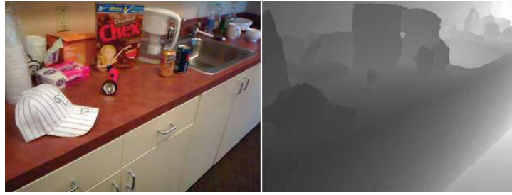
FIGURE 1.2 – Exemple d'une paire d'images \mathcal{RGB-D} . À gauche l'image \mathcal{RGB} et à droite la carte de profondeur \mathcal{D} correspondante. On peut la considérer comme une image en niveau de gris ou les valeurs des pixels correspondent à leur distance au capteur. Ici plus la distance est grande plus l'intensité lumineuse du pixel est élevée.
