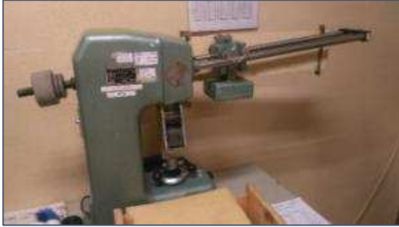
Figure 2-19 : Appareillage de mesure de résistances en flexion pour éprouvettes 4x4x16
