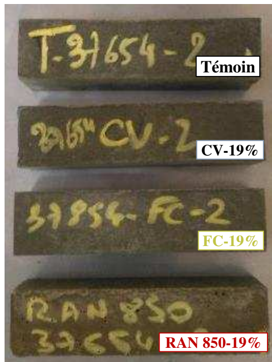
Figure 5-27 : Aspect des éprouvettes de mortier pour essais mécaniques à t = 24 h
