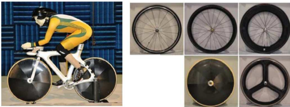
Figure 44 Méthode expérimentale avec le mannequin et détails des roues testées dans l'étude de Barry et al. (2012)
