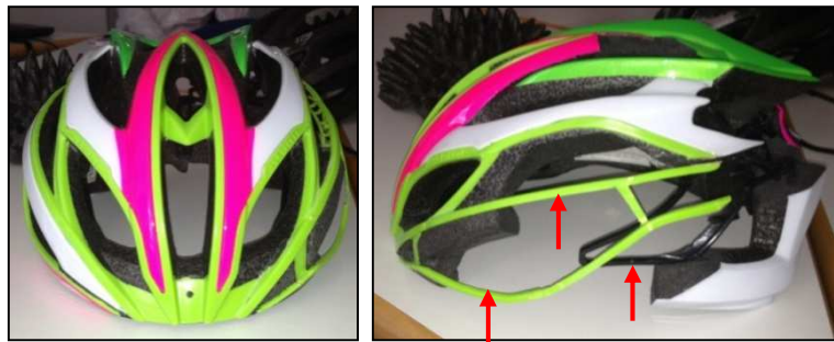
Figure 122 Prototype du casque Alpina Elexxion (flèches rouges mettant en évidence l'armature en plastique)
