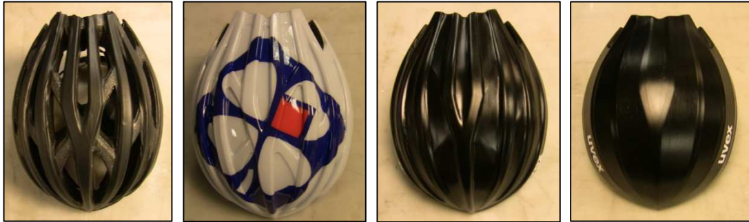
Figure 118 Casques FP5 standard, FP5 sprint avec coque externe sans aérations, FP5 avec coque externe prototype 1 et FP5 avec coque prototype 2
