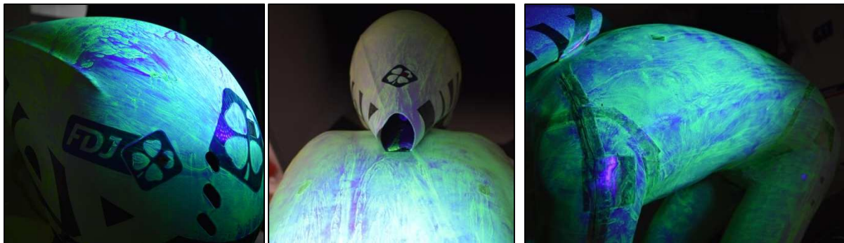
Figure 135 Visualisation des écoulements pariétaux sur le casque, le dos et le flanc
