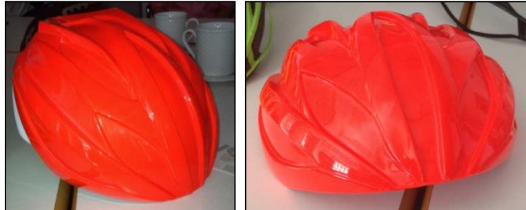
Figure 123 Coque externe sans aérations du modèle de casque Elexxion
