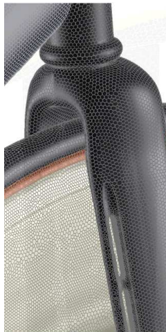
Figure 65 Exemple de maillage surfacique dans une étude CFD (Godo et al., 2011)
