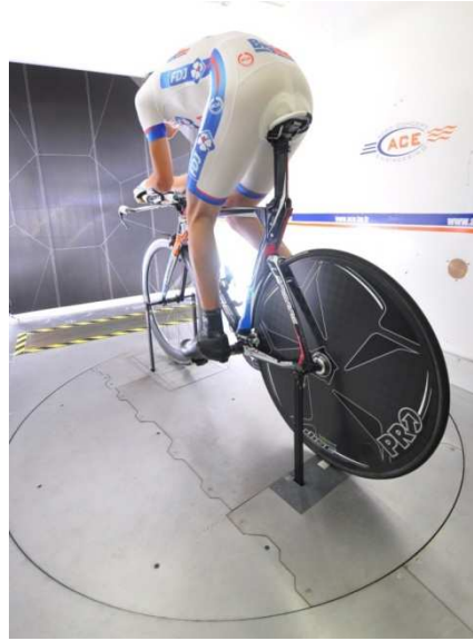
Figure 49 Veine d'essais en configuration « vélo » avec l'ensemble cycliste - vélo installé sur le plateau de mesure
