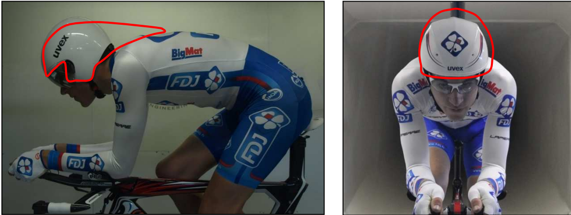
Figure 100 Superposition de la forme du casque Race 4 (en rouge) sur AJ
