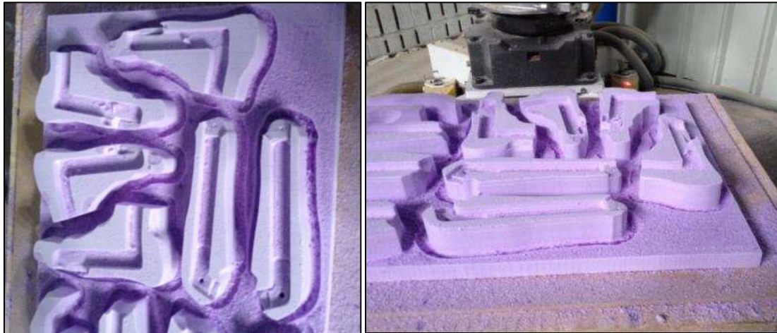
Figure 53 Etape 3 : usinage des différents segments (pied et avant-bras sur ces photos)
