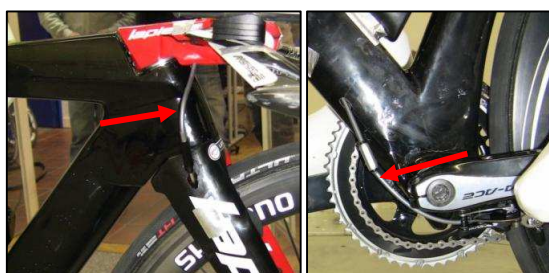
Figure 86 Câbles externes des freins avant (à gauche) et arrière (à droite)
