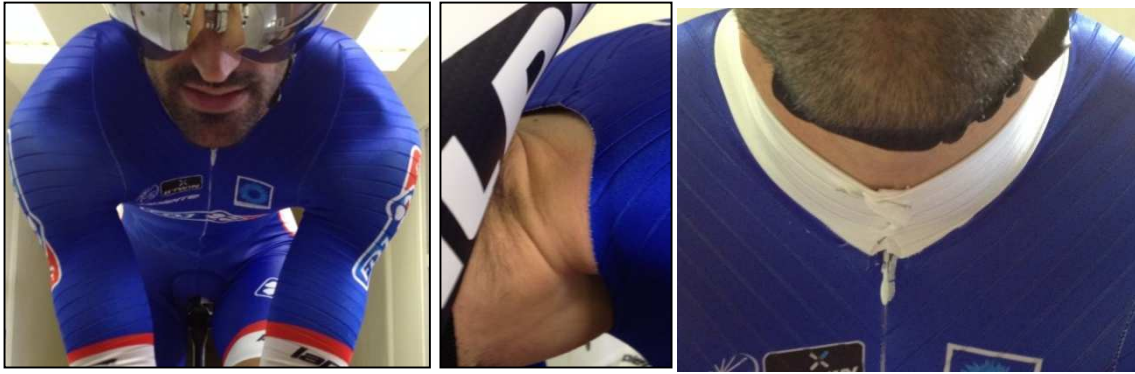
Figure 144 Combinaison prototype B'twin 2014. Au milieu : creux au niveau de la nuque. A droite : allongement de l'encolure.
