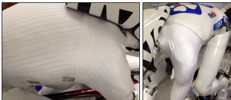
Figure 149 Essais des textiles B'twin rainuré (à gauche) et ultra-lisse Moa (à droite) dans le dos
