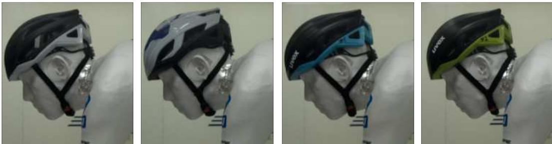
*Figure 120 Mannequin équipé avec les quatre casques testés*
