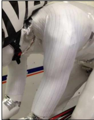
*Figure 148* Textile B'twin rainuré dans le sens vertical
