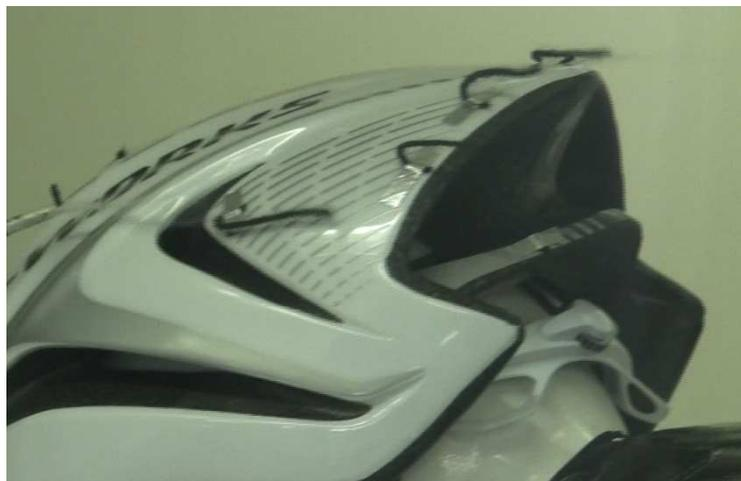
*Figure 58 Visualisation des écoulements pariétaux avec des fils de laine sur un casque*
