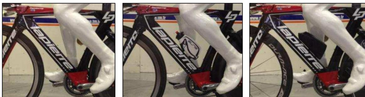
*Figure 93 Conditions testées : sans kit bidon, kit Elite 2012 et proto Elite 2013*
