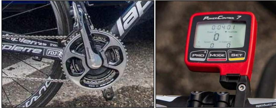
**Figure 22** Système SRM avec le pédalier (contenant les jauges de contraintes) et le compteur, (Powercontrol) récepteur et afficheur des données
