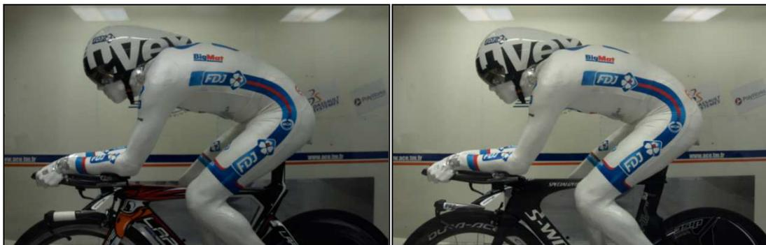
*Figure 71 Mannequin positionné sur les cadres de CLM Lapierre et Specialized*
