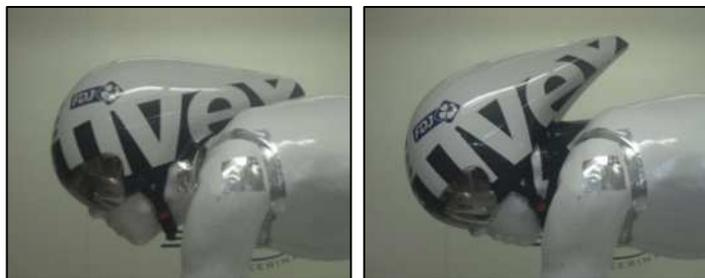
*Figure 112 Casques Uvex Race 6 sur le mannequin en position standard et position de tête inclinée vers le bas*
