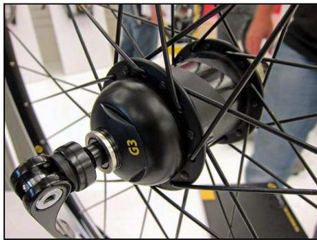
*Figure 24* Capteur de puissance Powertap avec le système de mesure à l'intérieur du moyeu
