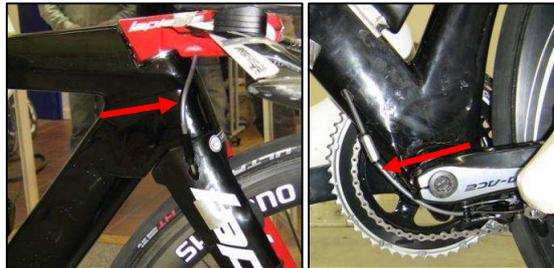
Figure 86 Câbles externes des freins avant (à gauche) et arrière (à droite)
