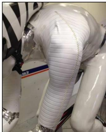
*Figure 147* Textile B'twin rainuré dans le sens horizontal avec bandelettes zig-zag
