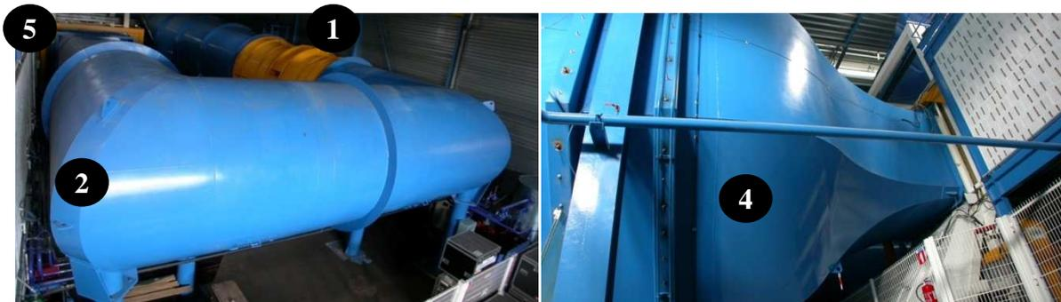
**Figure 48** Plan d'une soufflerie en circuit fermé à retours (Source : [www.larousse.fr](http://www.larousse.fr)) et vues extérieures de la soufflerie ACE : ventilateur (1), aubes de virage (2), chambre de tranquillisation (3), convergent (4), veine d'essais (5)
