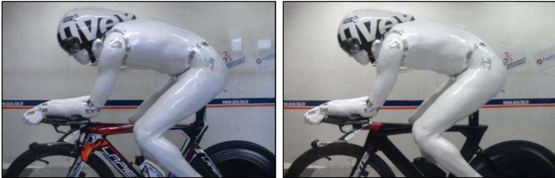
Figure 85 Mannequin posé sur les deux vélos de CLM Lapierre 2012 et Aerostorm
