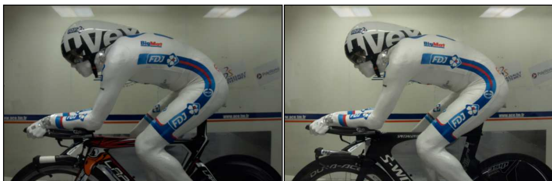
Figure 71 Mannequin positionné sur les cadres de CLM Lapierre et Specialized
