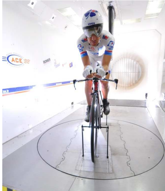
Figure 36 Veine d'essai de la soufflerie de Magny-Cours avec l'ensemble cycliste - vélo positionné sur la balance de force
