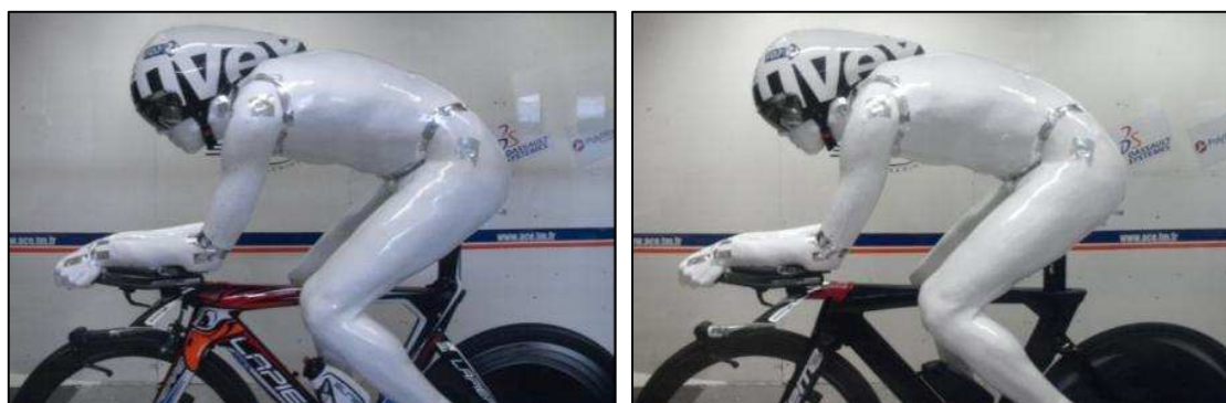
Figure 85 Mannequin posé sur les deux vélos de CLM Lapierre 2012 et Aerostorm
