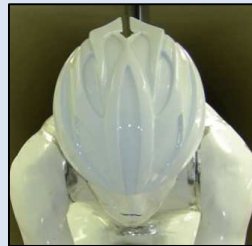
Figure 126 Coque externe choisie pour le modèle aérodynamique du casque Alpina Elexxion
