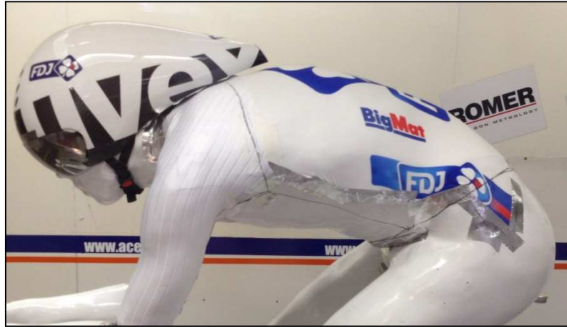
Figure 150 Configuration offrant les meilleurs gains aérodynamiques avec textile rainuré dans le sens vertical au niveau des bras et des épaules, et textile ultra-lisse Moa dans le dos
