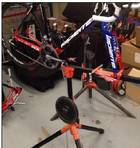
Figure 23 Etalonnage par une méthode statique du pédalier SRM
