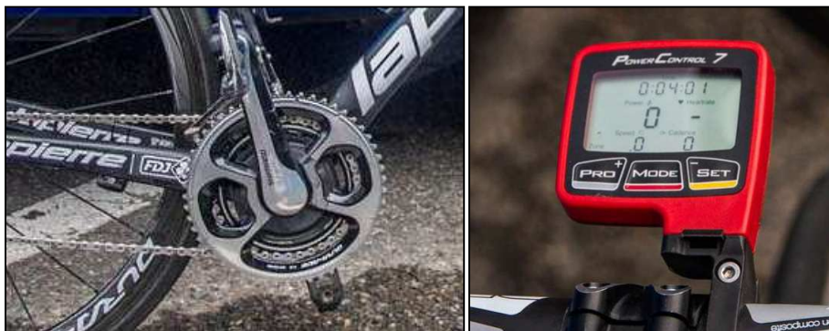
Figure 22 Système SRM avec le pédalier (contenant les jauges de contraintes) et le compteur, (Powercontrol) récepteur et afficheur des données
