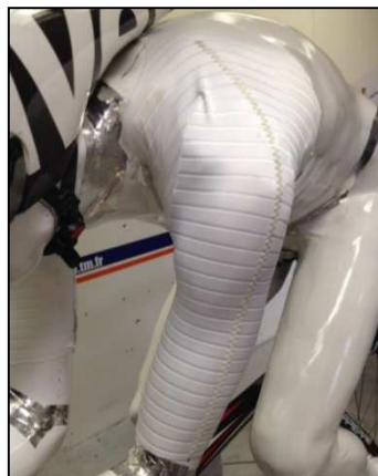
Figure 147 Textile B'twin rainuré dans le sens horizontal avec bandelettes zig-zag
