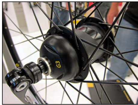
Figure 24 Capteur de puissance Powertap avec le système de mesure à l'intérieur du moyeu
