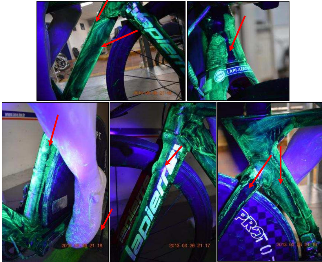
Figure 88 Lignes de frottement mises en évidence au niveau du tube diagonal, du tube de direction, du tube de selle, de la fourche et des haubans arrières
