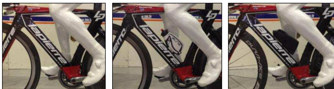
Figure 93 Conditions testées : sans kit bidon, kit Elite 2012 et proto Elite 2013
