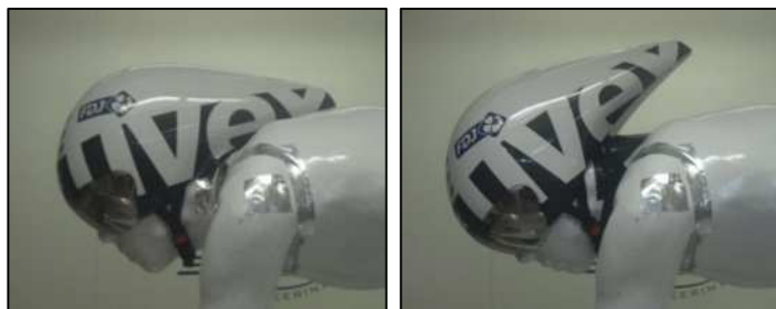
Figure 112 Casques Uvex Race 6 sur le mannequin en position standard et position de tête inclinée vers le bas
