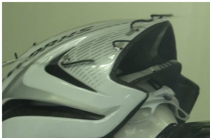
Figure 58 Visualisation des écoulements pariétaux avec des fils de laine sur un casque
