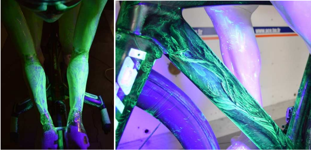
Figure 57 Visualisation des écoulements pariétaux
