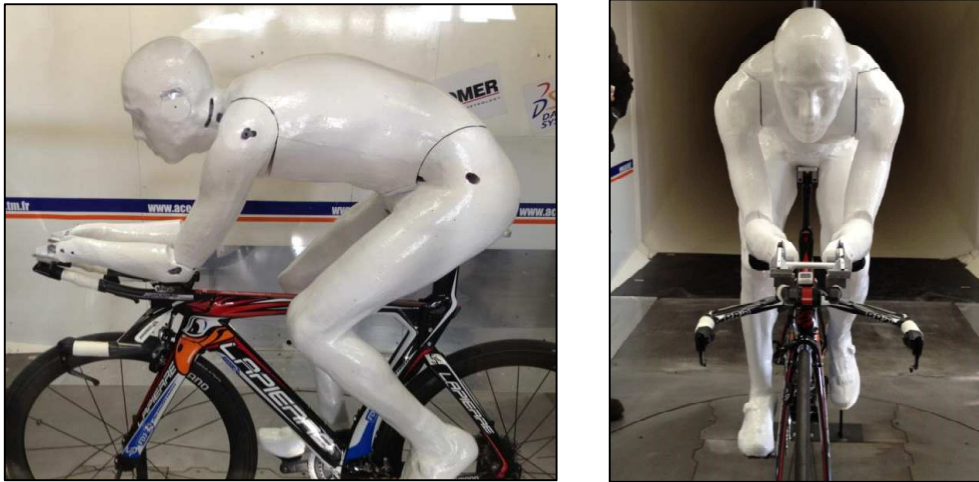
Figure 55 Premier montage du mannequin sur le vélo de CLM
