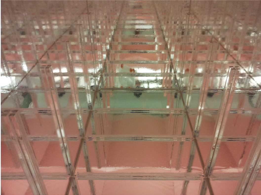
FIGURE 2.7 – Photos d'une cellule de STEREO avec ses parois réfléchissantes.
