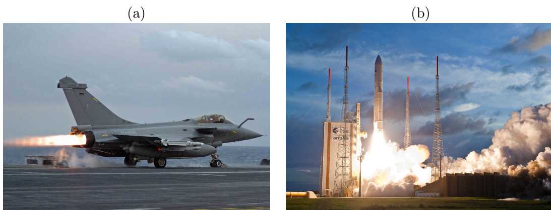
FIGURE 1 – Jets supersoniques issus des tuyères (a) du Rafale et (b) du lanceur Ariane 5. (sources : Marine Nationale et ArianeGroup)
