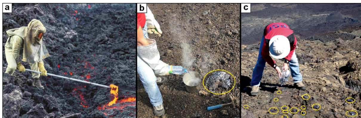
Figure 3.2 – (a) Echantillonnage syn-éruptif d'une coulée de lave, proche de sa source d'émission, lors de l'éruption de Juillet 2015. (b) Echantillonnage syn-éruptif de bombes et lapilli incandescents récupérés peu après leur émission proche de l'événement, lors de l'éruption de Avril-Mai 2018. Une trempe est ensuite effectuée dans l'eau à la fois pour les laves et les téphras. (c) Echantillonnage post-éruptif de lapilli et petites bombes, après l'éruption de Juin 2014 (Gurioli et al. 2018).
