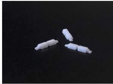
Figure IV-7- Filtres 2 pôles après calcination/ recuit
