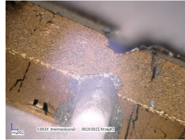
Figure IV-29- Manque de métallisation au niveau des congés et des iris
