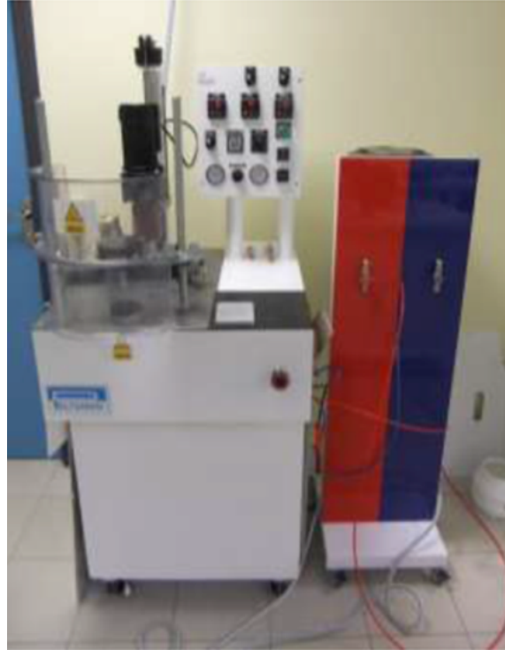
Figure I-40 - Presse à injection basse pression et système de thermorégulation
