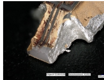
Figure IV-31- Décollement de la métallisation
