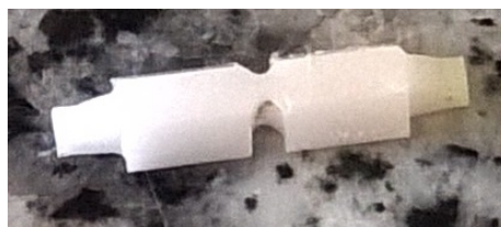
Filtre après décollage et nettoyage
