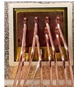
Figure I.18: Image d’une métallisation en cuivre [Jia18]
