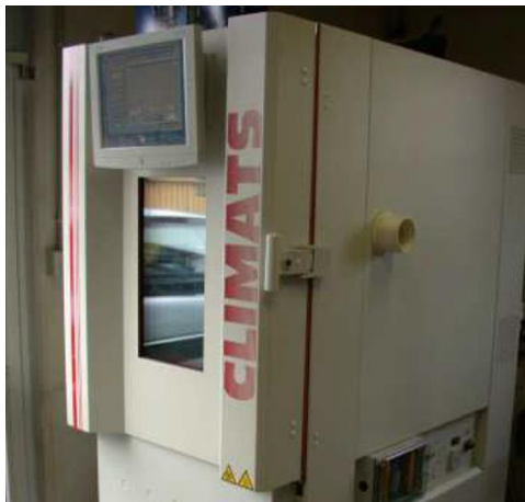
Figure I.53: Enceinte climatique utilisée pour la réalisation de TCTs [Bou08]
