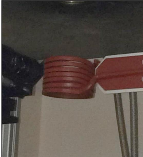
**Figure 7:** Inducteur (spire) pour chauffage radiofréquence ( $\mu$ -PD).
