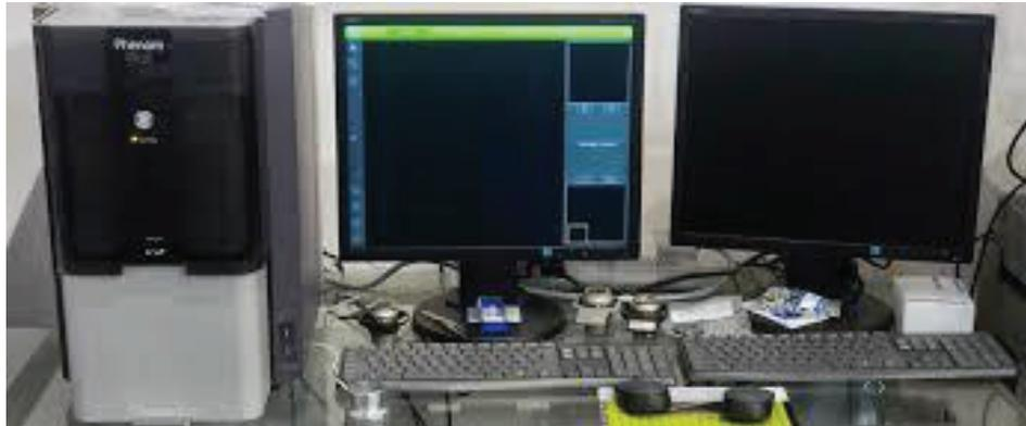
**Figure 24:** *Le MEB (Phenom ProX) utilisé dans le cadre de cette thèse.*
