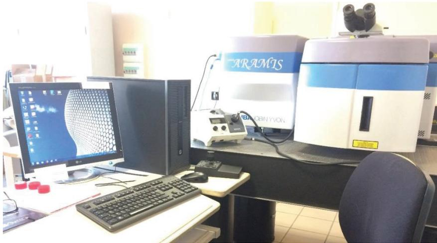
**Figure 26:** *Spectromètre Raman ARAMIS utilisé dans cette thèse.*
