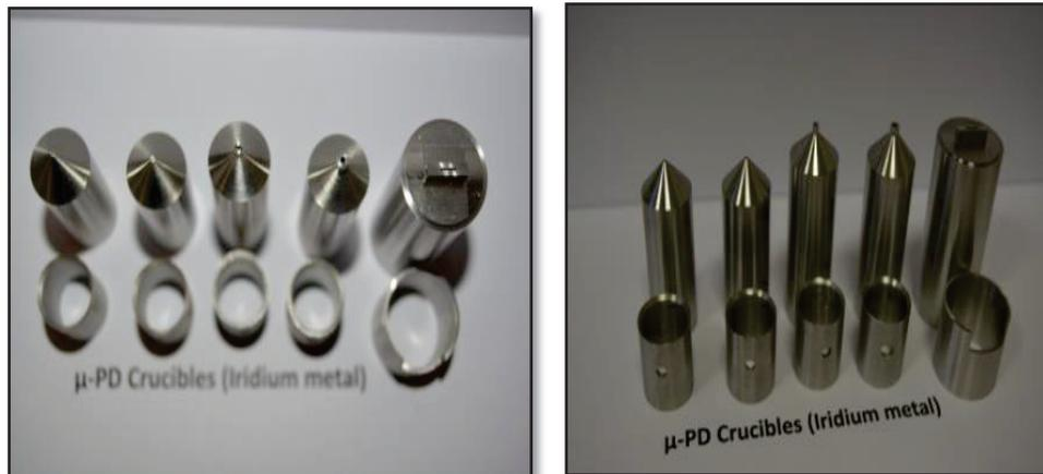
**Figure 15:** *Creusets et after-heater avec différentes géométries.*
