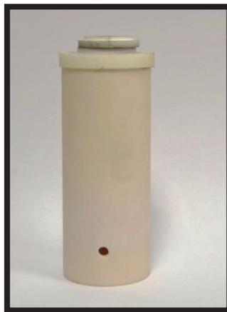
**Figure 17:** *Isolation thermique (tube en céramique) utilisée dans ce projet.*
