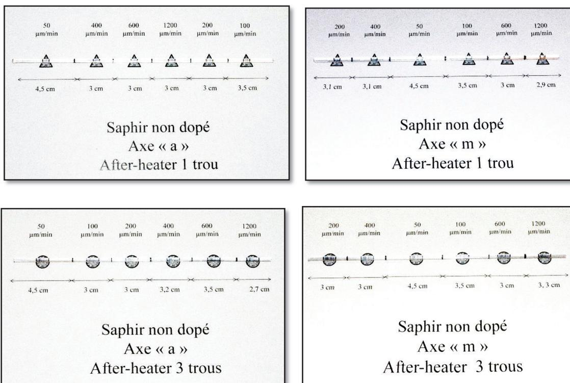
Figure 20: Barreaux de saphir tirés avec différentes vitesses de tirage.
