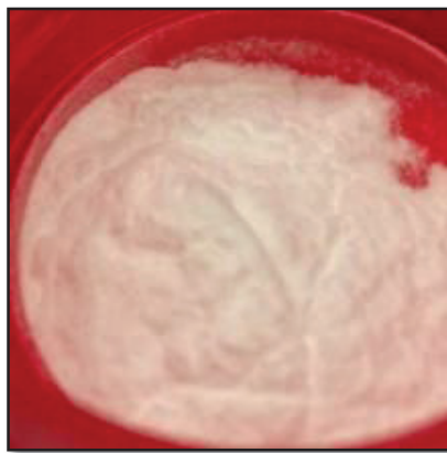
Figure 12: Poudre d'Alumine ( \text{Al}_2\text{O}_3 ) utilisée pour le tirage des barreaux de saphir [26].
