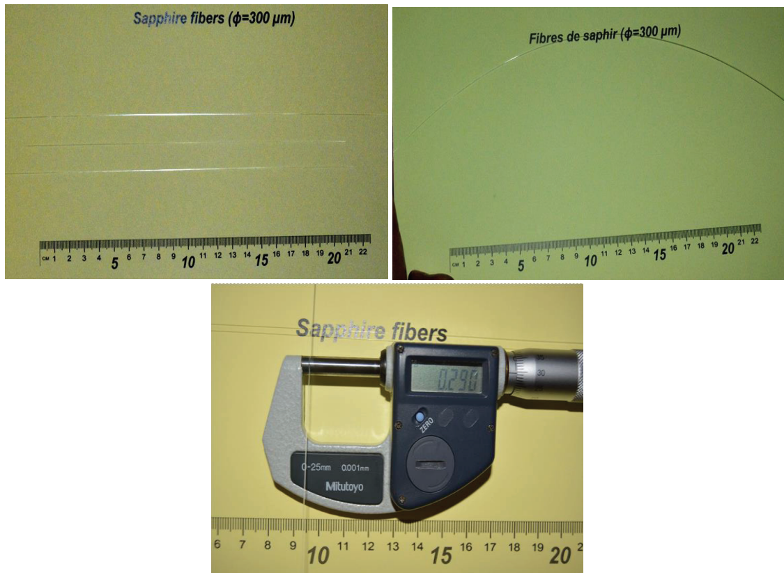
Figure 10: Fibres de saphir de diamètre \leq 300\mu\text{m} orienté suivant l'axe-c.
