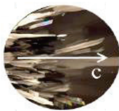
Figure 16: Sous-joints de grain d'un échantillon de saphir découpé d'un lingot cristallisé par la méthode de Verneuil.
