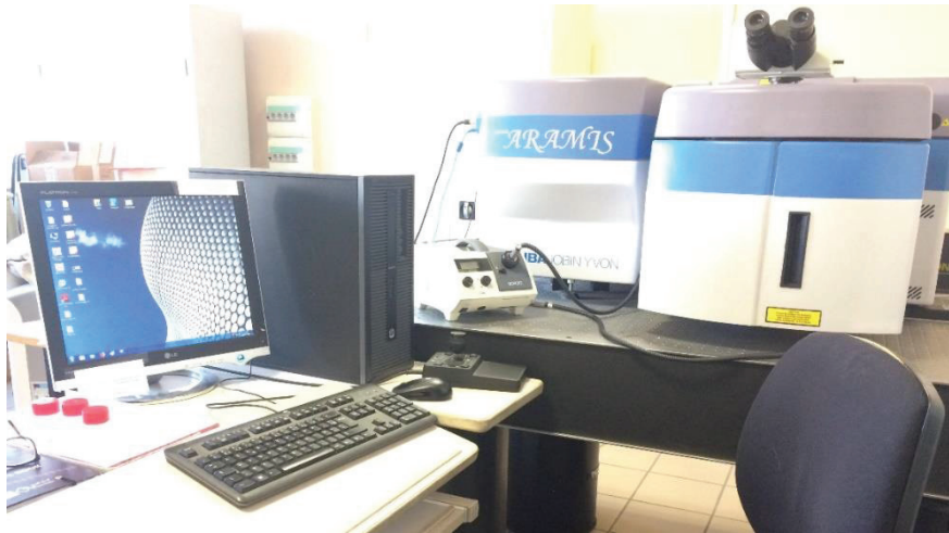
Figure 26: Spectromètre Raman ARAMIS utilisé dans cette thèse.
