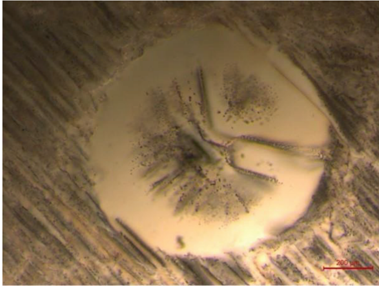
Figure 8: Section transversale d'un barreau de saphir tiré par \mu -PD avec une vitesse de tirage de 3000 \mu\text{m}/\text{min} . Présence des bulles dans la partie centrale du barreau [6].
