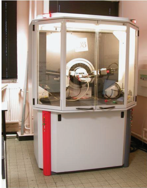
Figure 28: Diffractomètre RX utilisé dans le cadre de cette thèse.
