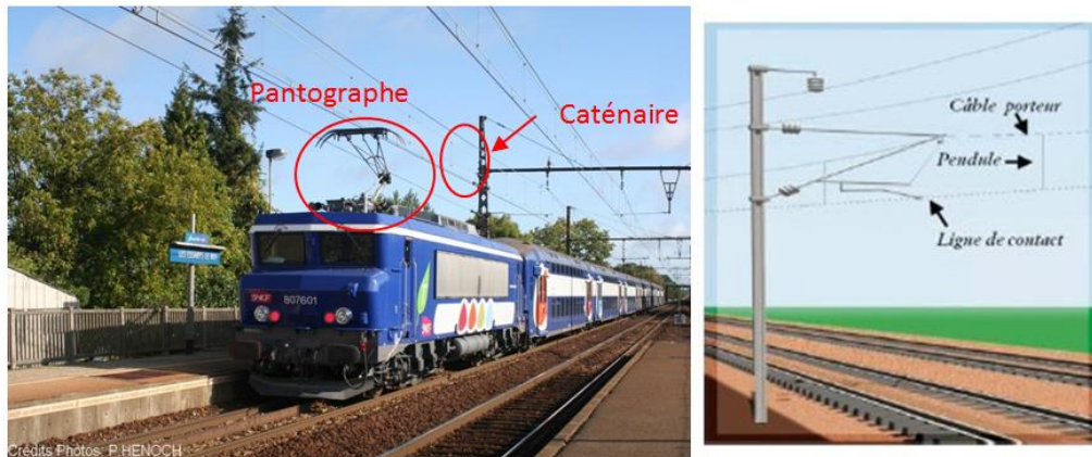
Figure 2: Une caténaire est composée de câbles porteurs en bronze ou en aluminium, de ligne de contact et de câbles conducteurs en cuivre
