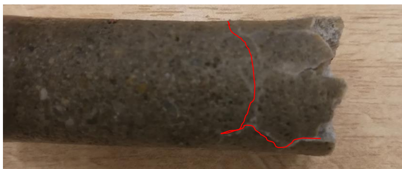
Figure 2.29. Fissures sur éprouvette CEM I-3-24 dégradée
