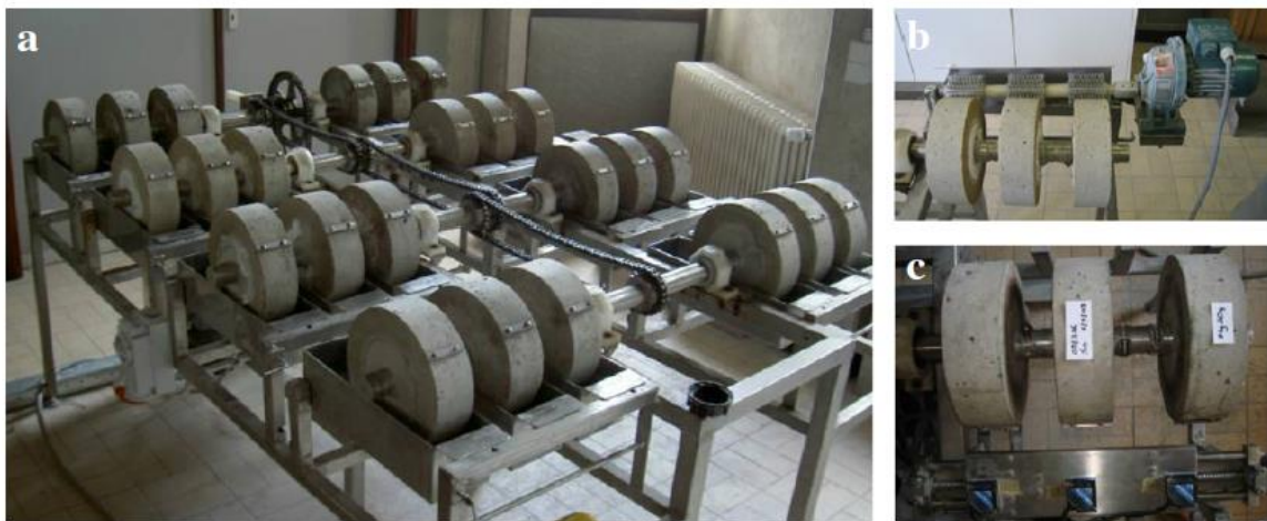
Figure 30. Dispositif pour les essais de dégradation (Gruyaert et al., 2012)
