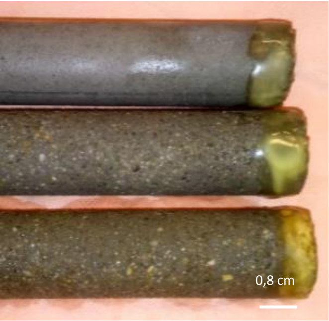
CEM V 1 témoin (haut), avec pré-conditionnement à 8 mois (milieu), sans pré-conditionnement à 18 mois (bas)
