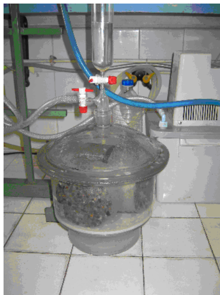
Figure 32. Dispositif de saturation sous vide (Messad, 2009)
