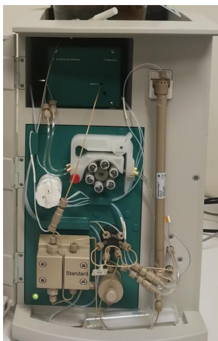
Figure 4.11. Chromatographie ionique avec la colonne échangeuse d'ions sur la droite
