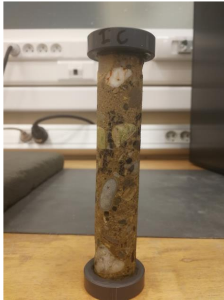
Figure 3.26. Eprouvette de béton B17 dégradée à 407 jours
