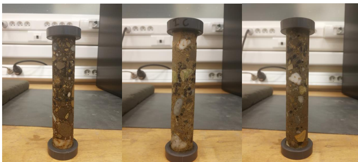
Figure 3.33. Eprouvettes de bétons dégradées B15 (280 jours, gauche), B17 (400 jours, milieu) et B18 (400 jours, droite)
