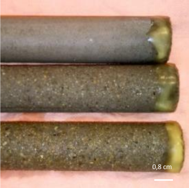
CEM V 2 témoin (haut), avec pré-conditionnement à 8 mois (milieu), sans pré-conditionnement à 18 mois (bas)
