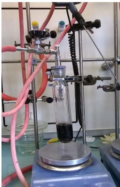
Figure 106 : Synthèse de NPs de RuPt dans une bouteille de Fisher Porter.
