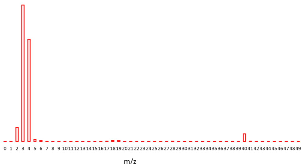
Figure 176 : Spectre MS en phase gaz après réaction de la phénylalanine dans H 2 O sous 2 bars de D 2 .
