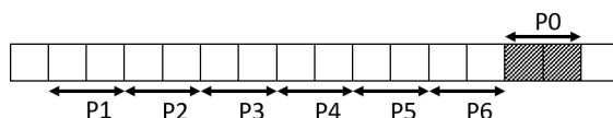
FIGURE 8.3 – Différentes positions du second patch de la zone locale, le premier se trouvant toujours au niveau de P0. Un patch est constitué de deux éléments macro.
