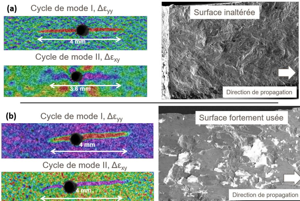
FIGURE 19 – (a) : fissure apparente durant les cycles de mode I et II, et faciès de rupture de l’essai N° 9 (13 / 0 kN,  $\pm 90$  Nm). (b) : fissure apparente durant les cycles de mode I et II, et faciès de rupture de l’essai N° 6 (10 / -5 kN,  $\pm 150$  Nm).
