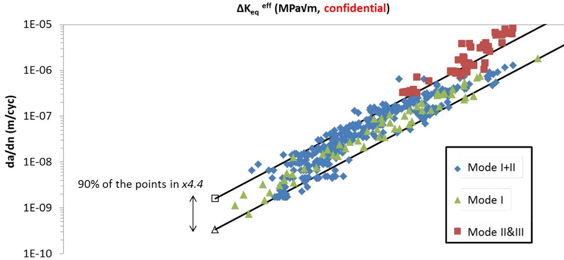
FIGURE 20 – Evolution de la vitesse de propagation pour les essais de mode I, mode mixte II & III et mode mixte non-proportionnel I + II en fonction de  $\Delta K_{eq}^{eff} = \sqrt{(\Delta K_I^{eff})^2 + (\Delta K_{II}^{eff})^2 + \frac{1}{1-\nu}(\Delta K_{III}^{eff})^2}$ .
