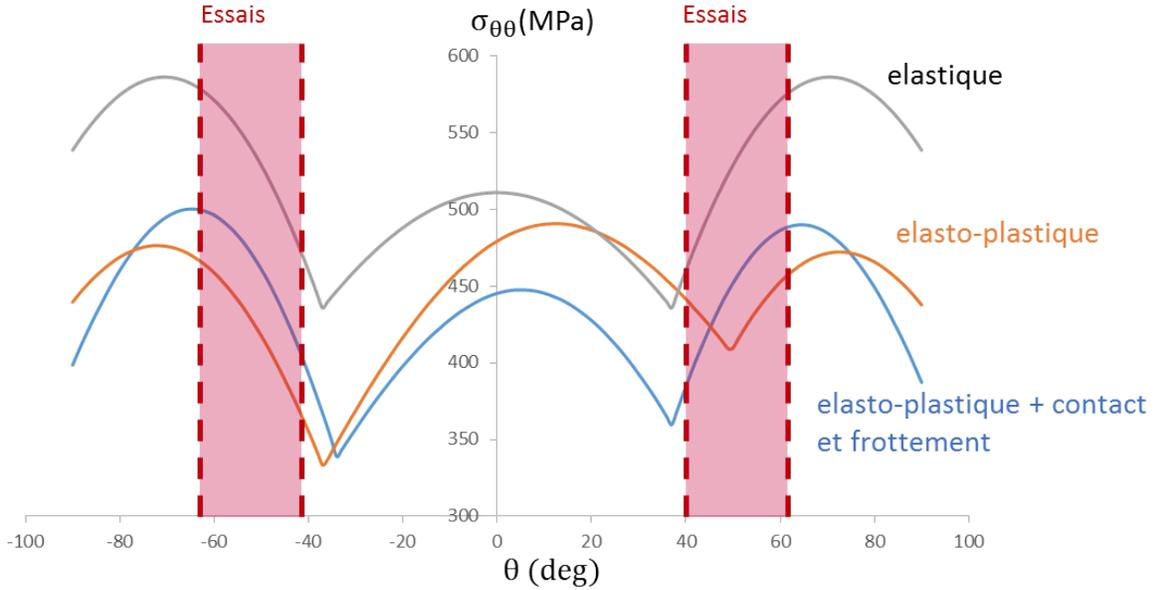
FIGURE 21 – Evolution du maximum temporel de la contrainte tangentielle devant la pointe, en fonction de l'angle. Calcul élément fini avec  $\Delta K_{II}^{eff} / \Delta K_I^{eff} = 2$ ,  $R_I = -1$  et  $U_{II} = 0.5$ .
