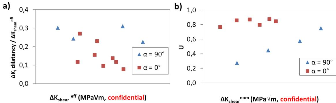
FIGURE 10 – Evolution de  $U = \Delta K^{eff} / \Delta K^{nom}$  et  $\Delta K_I^{eff} / \Delta K_{shear}^{eff}$ .
