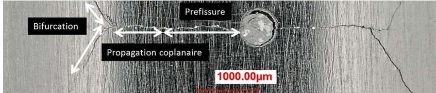
FIGURE 15 – Exemple de trajet de fissure.
