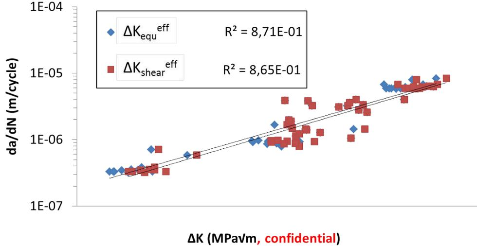
FIGURE 12 - Evolution de la vitesse de propagation coplanaire en fonction de  $\Delta K_{equ}^{eff} = \sqrt{\Delta K_{II}^{effective^2} + 1.25\Delta K_{III}^{effective^2}}$  et  $\Delta K_{shear}^{eff} = \sqrt{E * \Delta G_{shear}^{eff} / (1 - \nu^2)}$ .
