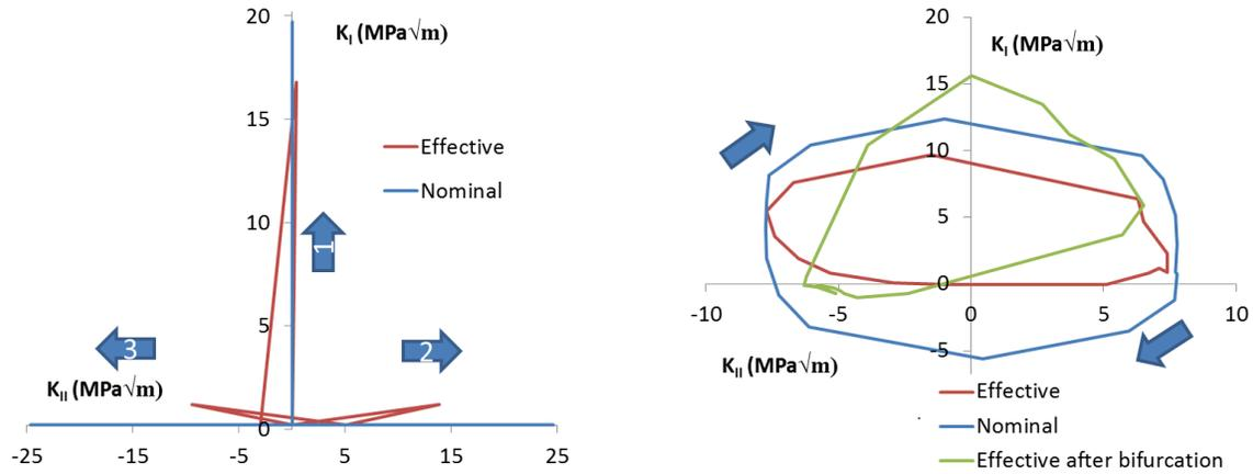
FIGURE 17 – Trajets de chargements pour l’essai séquentiel  $N^\circ 19$  ( $F = +10/0 \text{ kN}$ ,  $C = \pm 90 \text{ Nm}$ ), au cycle 45000 (gauche), et l’essai déphasé de  $90^\circ$   $N^\circ 14$  ( $F = +11/-5 \text{ kN}$ ,  $C = \pm 70 \text{ Nm}$ ), au cycle 5000 (avant bifurcation) et 65000 (après bifurcation) (droite).
