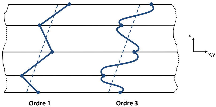
FIGURE 1.5 – Exemples de champs de déplacement postulés par les modèles Zig-Zag avec une description linéaire (ordre 1) et cubique (ordre 3) du cisaillement dans le cas d'un multicouche composé de 4 couches.
