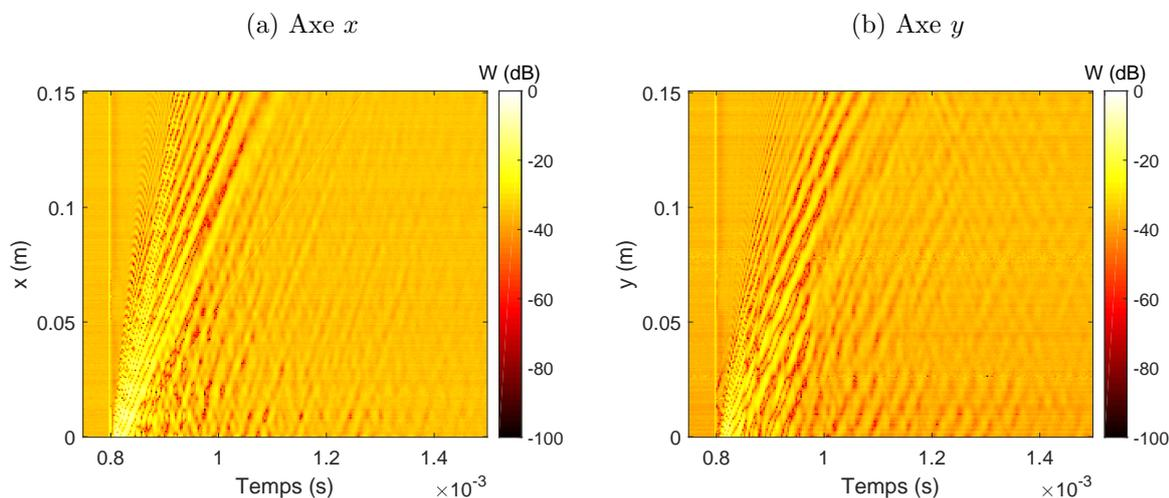
FIGURE 4.4 – Déplacement transverse mesuré sur le sandwich en nids d'abeille avec une excitation au laser. Axe temporel compris entre 0.75 et 1.5 ms. Résultats dans les directions  $x$  (a) et  $y$  (b).
