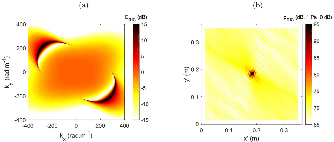
FIGURE 3.12 – Réponse de RIC pour  $n_x = n_y = 3$  (a) et champs de pression reconstruits par RIC intégrés de 1 à 10 kHz (b). Calcul des coefficients correcteurs avec  $\theta \in [0^\circ : 90^\circ]$ . Résultats obtenus à partir de la simulation d’une plaque anisotrope (paramètres matériaux au Tableau 3.1).
