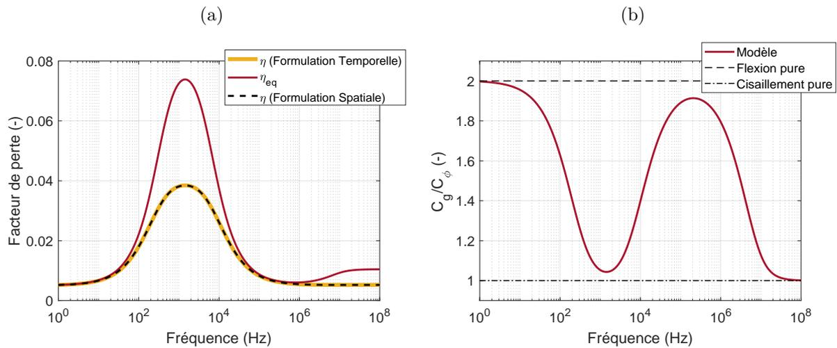
FIGURE 2.20 – (a) Amortissement équivalent (—) et énergétique avec la formulation temporelle (—) et spatiale (---) du mode de flexion d'un sandwich isotrope (caractéristiques des couches au Tableau 2.2). Amortissement des peaux : 0.5%. Amortissement du cœur : 4%. (b) Ratio entre les vitesses de groupe et de phase de ce même mode.
