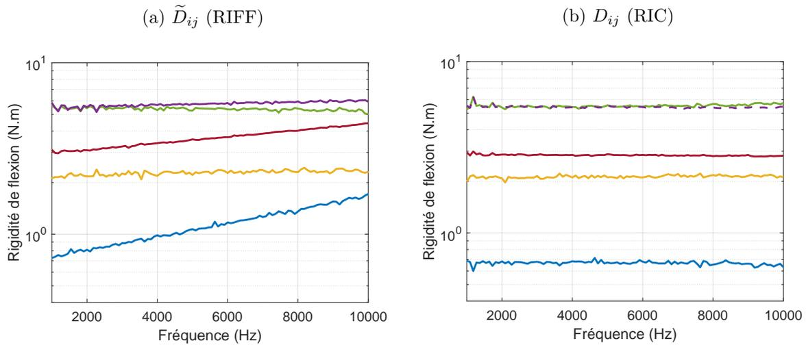
FIGURE 3.29 – Rigidités de flexion ( $D_{11}$  (—),  $D_{22}$  (—),  $D_{12}$  (—),  $D_{16}$  (—),  $D_{26}$  (—)), estimées par RIFF (a) et par RIC (b) avec l’approche itérative (30 itérations). RSB=30 dB. Technique de régularisation de RIFF. Résultats obtenus à partir de la simulation d’une plaque anisotrope (paramètres matériaux au Tableau 3.1).
