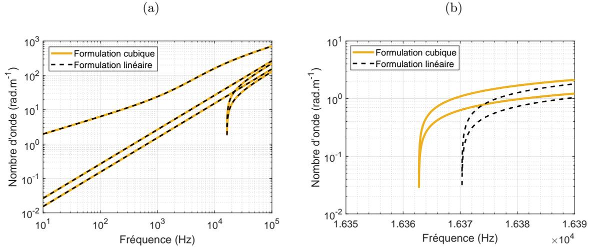
FIGURE B.2 – Courbes de dispersion (a) d’un sandwich isotrope (caractéristiques des couches au Tableau B.1) obtenues à partir d’une représentation cubique (—) et linéaire (—) de la forme du cisaillement. Zoom sur les modes de cisaillement (b).
