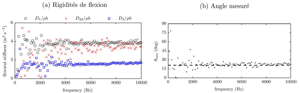
FIGURE 1.13 – Application expérimentale de RIFF sur une plaque en composite en fibres de verre inclinée de  $21^\circ$ . Rigidités de flexion identifiées (a). Angle mesuré (b). Résultats issus des travaux de Ablitzer *et al.* [2].
