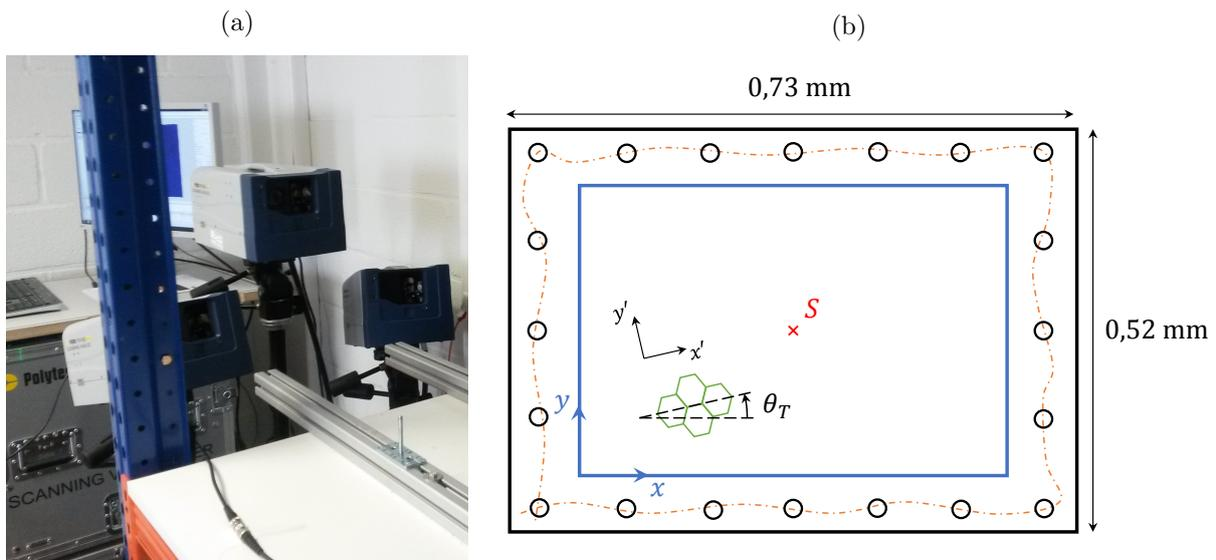
FIGURE 4.2 – (a) Vibromètre laser 3D (Polytec PSV-500-3D XTRA). (b) Configuration de la mesure effectuée sur la plaque sandwich en nids d'abeille. Position de la source ( $\times$ ). Zone mesurée ( $\text{—}$ ). Corde amortissante ( $\text{---}$ ).
