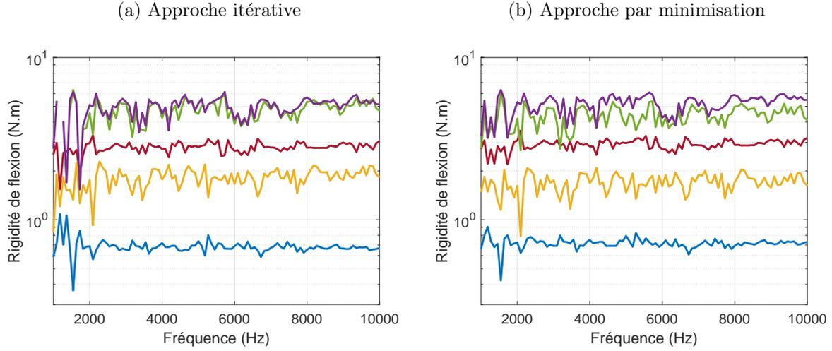
FIGURE 3.25 – Rigidités de flexion ( $D_{11}$  (—),  $D_{22}$  (—),  $D_{12}$  (—),  $D_{16}$  (—),  $D_{26}$  (—)), estimées par RIC avec l’approche itérative (a) et par minimisation (b). RSB=30 dB. Technique de régularisation de RIC. Résultats obtenus à partir de la simulation d’une plaque anisotrope (paramètres matériaux au Tableau 3.1).
