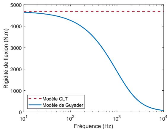
FIGURE 1.6 – Rigidité de flexion d'un sandwich isotrope, composé de peaux en aluminium ( $h = 1$  mm,  $E = 70$  GPa,  $\rho = 2700$  kg.m<sup>-3</sup>,  $\nu = 0.3$ ) et d'une âme visqueuse ( $h = 10$  mm,  $E = 0.3$  GPa,  $\rho = 400$  kg.m<sup>-3</sup>,  $\nu = 0.3$ ) calculé à partir de la théorie CLT (---) et de l'équivalence plaque mince du modèle de Guyader et Cacciolati (—).
