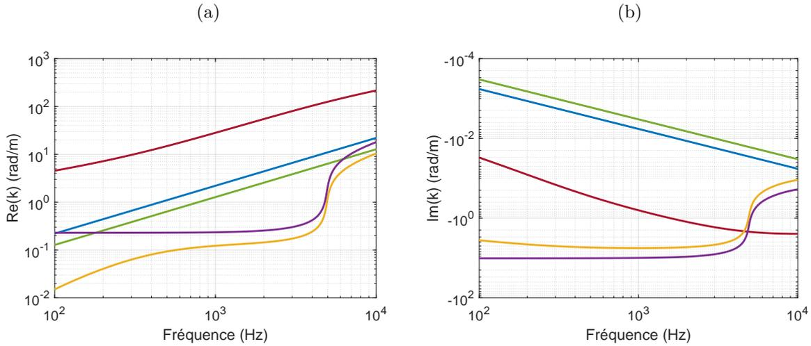
FIGURE 2.19 – Courbes de dispersion dans la direction  $x$  d'un sandwich isotrope (caractéristiques des couches au Tableau 2.2). Amortissement des peaux : 0.5%. Amortissement du cœur : 4%. Partie réelle (a) et imaginaire (b) du nombre d'onde. Flexion (—), Membrane (—), Membrane transverse (—), Cisaillement (—), Cisaillement transverse (—).
