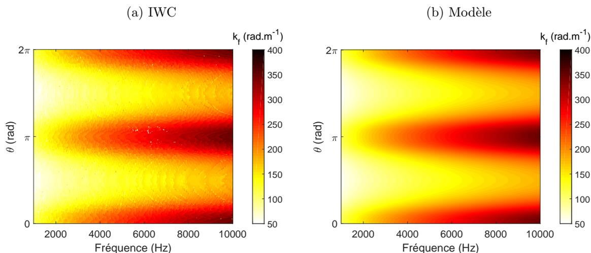
FIGURE 2.10 – Nombre d'onde naturel de flexion  $k_f$  de la plaque composite d'empilement uniforme identifié expérimentalement avec la méthode IWC (a) et calculé analytiquement avec le modèle multicouche (b) en fonction de la fréquence et de la direction.
