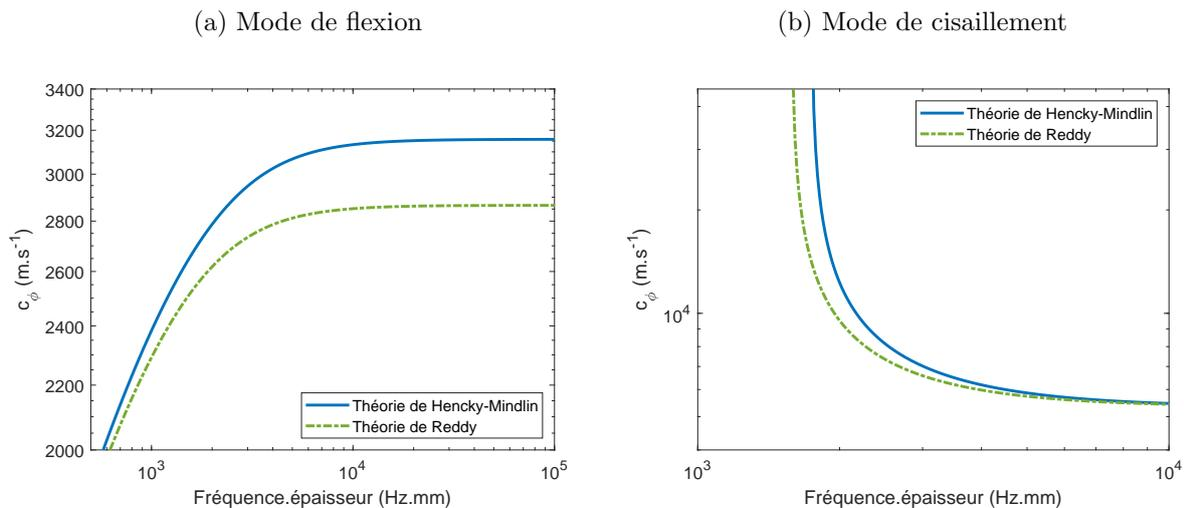
FIGURE 1.3 – Vitesse de phase des modes de flexion (a) et de cisaillement (b) d'une plaque d'aluminium ( $E = 70$  GPa,  $\rho = 2700$  kg.m<sup>-3</sup>,  $\nu = 0.3$ ) en fonction du produit fréquence-épaisseur. Modélisation en plaque épaisse de Hencky-Mindlin (—) et de Reddy (---).
