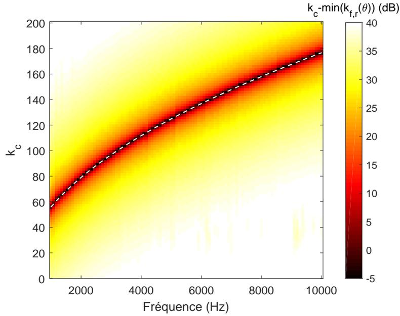
FIGURE 3.28 – Cartographie de  $|k_c - \min(k_{f,r}(\theta))|$  permettant de choisir le nombre d’onde de coupure optimal dans la technique de régularisation de RIFF. Valeur théorique de  $\min(k_f(\theta))$  (tirets blanc). Résultats obtenus à partir de la simulation d’une plaque anisotrope (paramètres matériaux au Tableau 3.1). RSB=30 dB.
