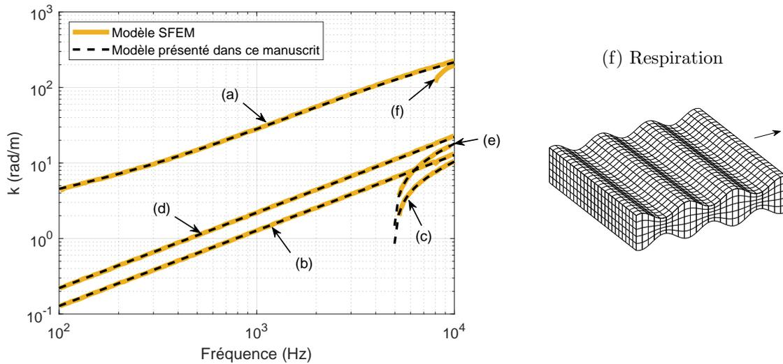
FIGURE 2.6 – Courbes de dispersion dans la direction  $x$  d'un sandwich isotrope (caractéristiques des couches au Tableau 2.2). Résultats du modèle SFEM utilisé par Shorter [115] (—), Résultats de notre modèle (---). Schéma du mode de respiration (f).
