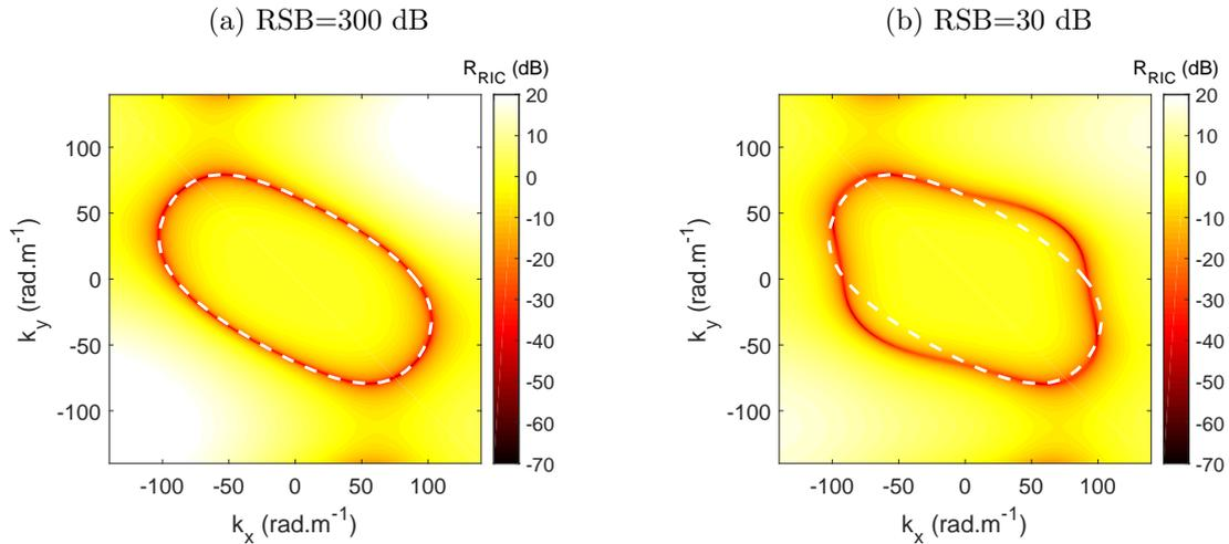
FIGURE 3.26 – Cartographie de  $\mathcal{R}_{\text{RIC}}$  obtenues à 1 kHz à partir d’un RSB de 300 dB (a) et de 30 dB (b). Nombre d’onde de flexion théorique (tirets blanc).  $n_{\text{opt}} = 3.5$ . Résultats obtenus à partir de la simulation d’une plaque anisotrope (paramètres matériaux au Tableau 3.1).
