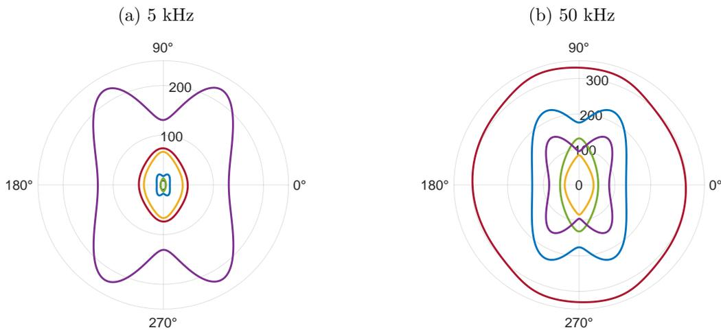
FIGURE 2.5 – Surfaces de dispersion (en valeur absolue) à 5 kHz (a) et 50 kHz (b) d'un sandwich anisotrope (caractéristiques des couches au Tableau 2.1). Flexion (—), Membrane (—), Membrane transverse (—), Cisaillement (—), Cisaillement transverse (—).
