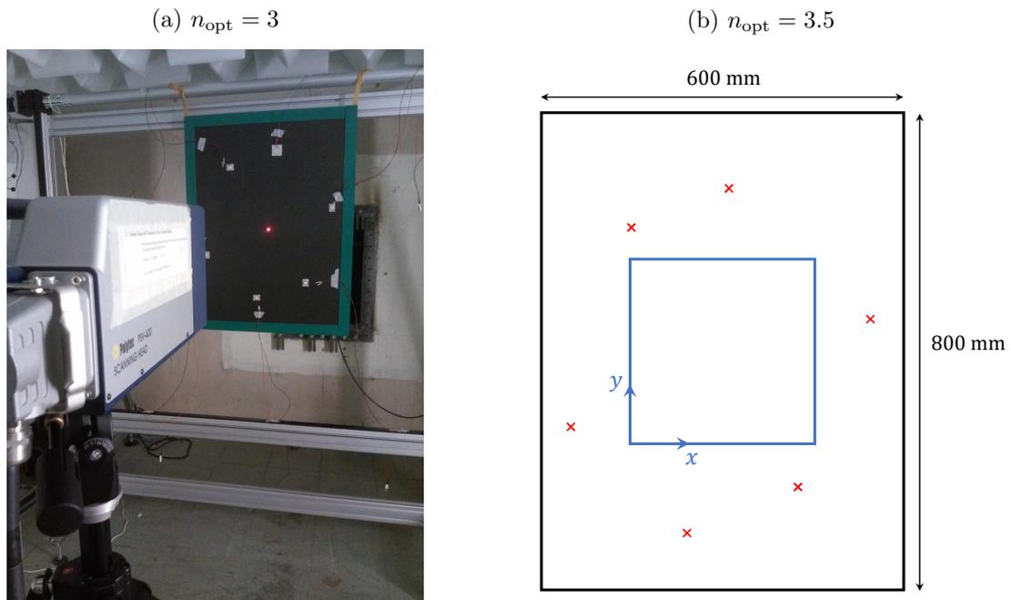
FIGURE 3.32 – Configuration de la mesure expérimentale réalisée sur les plaques en composites pour l'identification de paramètres matériaux avec RIC. Position des sources ( $\times$ ). Zone mesurée ( $\square$ ).
