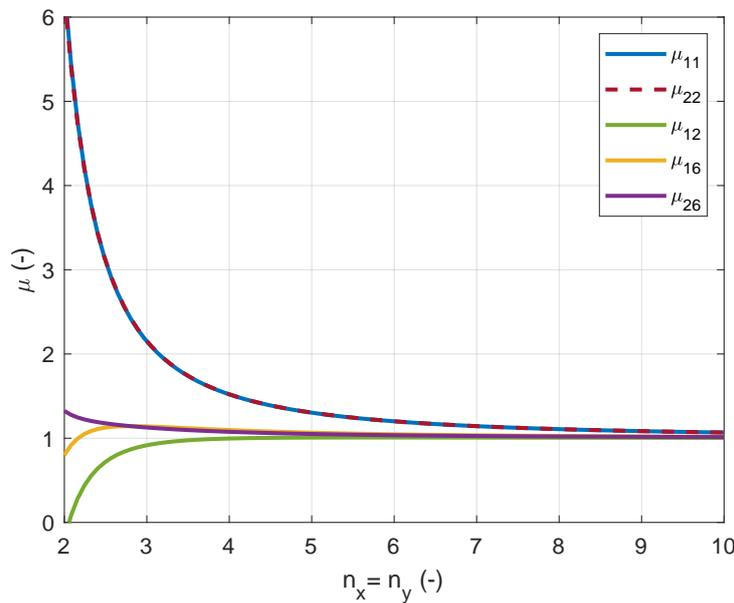
FIGURE 3.6 – Valeur des coefficients correcteurs de la méthode RIC en fonction du nombre de points par longueur d'onde ( $n_x = n_y$ ). Résultats obtenus à partir des caractéristiques de la plaque composite à empilement laminaire (caractéristiques des couches au Tableau 2.3) à 10 kHz.  $\mu_{11}$  (—),  $\mu_{22}$  (- -),  $\mu_{12}$  (—),  $\mu_{16}$  (—),  $\mu_{26}$  (—).
