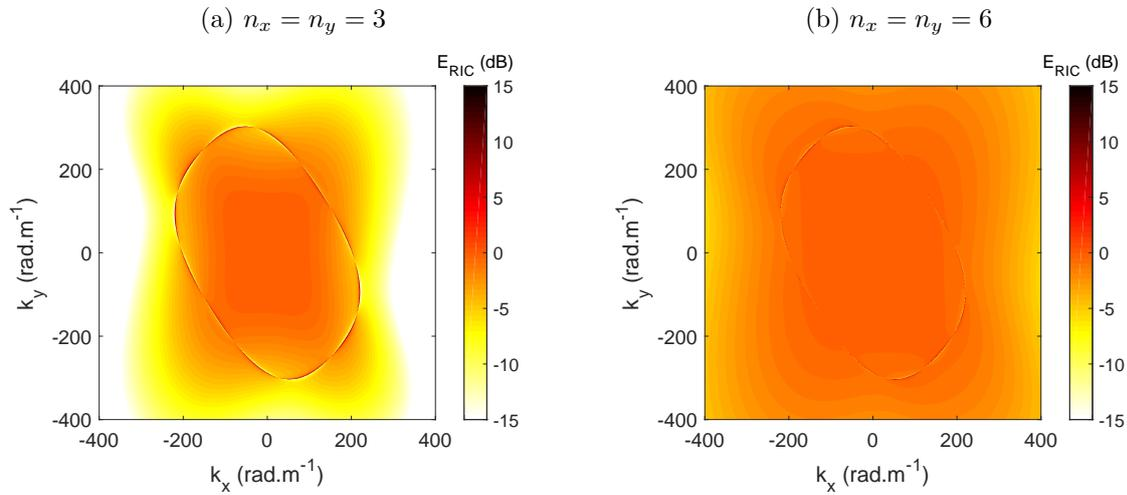
FIGURE 3.5 – Réponse de RIC dans le domaine des nombres d'onde pour  $n_x = n_y = 3$  (a) et  $n_x = n_y = 6$  (b). Résultats obtenus à partir des caractéristiques de la plaque composite à empilement laminaire (caractéristiques des couches au Tableau 2.3) à 10 kHz.
