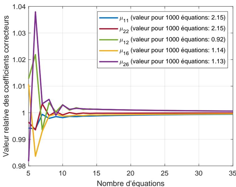
FIGURE 3.4 – Valeurs des coefficients correcteurs de la méthode RIC en fonction du nombre d'équation de l'approche moindres carrés (divisée par leur valeur pour 1000 équations). Résultats obtenus à partir des caractéristiques de la plaque composite à empilement laminé (caractéristiques des couches au Tableau 2.3) à 10 kHz.  $n_x = n_y = 3$ .  $\mu_{11}$  (—),  $\mu_{22}$  (—),  $\mu_{12}$  (—),  $\mu_{16}$  (—),  $\mu_{26}$  (—).
