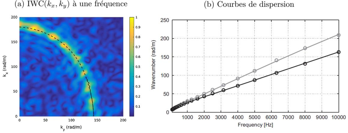
FIGURE 1.9 – Application de la méthode IWC sur une plaque en composite. (a)  $IWC(k_x, k_y)$  à une fréquence. Corrélation maximale (---). (b) Courbes de dispersion du mode de flexion dans les directions  $x$  (—) et  $y$  (—) obtenues par IWC (cercles) en comparaison avec des valeurs théoriques (lignes). Résultats issus des travaux de Cherif *et al.* [22].
