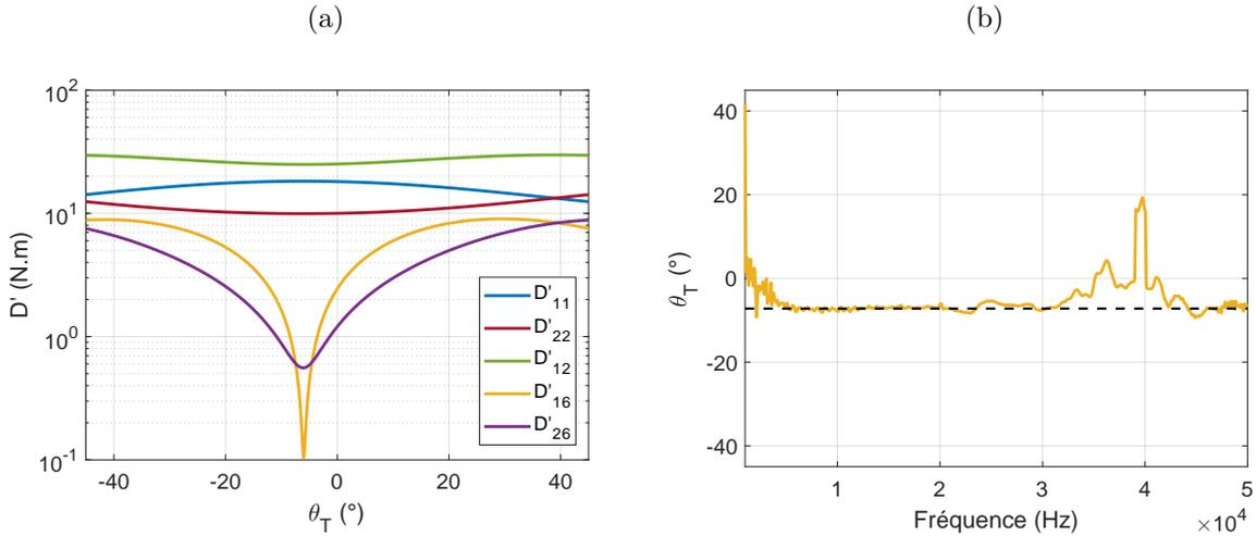
FIGURE 4.7 – Rigidités de flexion  $D'$  calculées avec l'Eq. (4.1) à partir des rigidités estimées par RIC à 20 kHz (a). Angle d'orthotropie (—) identifié à partir des résultats de RIC (b). Valeur d'angle d'orthotropie sélectionnée :  $\theta_T = -7^\circ$  (---).
