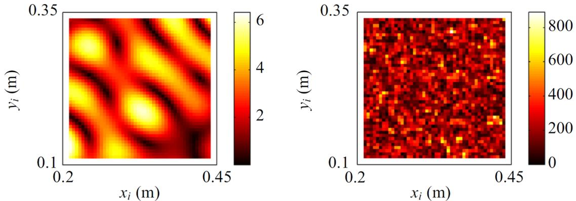
FIGURE 1.11 – Exemple d'opérateur bilaplacien ( $\text{m}^{-3}$ ) calculé à partir de champ de déplacement non bruité (a) et bruité avec un rapport signal à bruit RSB=40 dB (b). Résultats issus des travaux de Ablitzer *et al.* [1].
