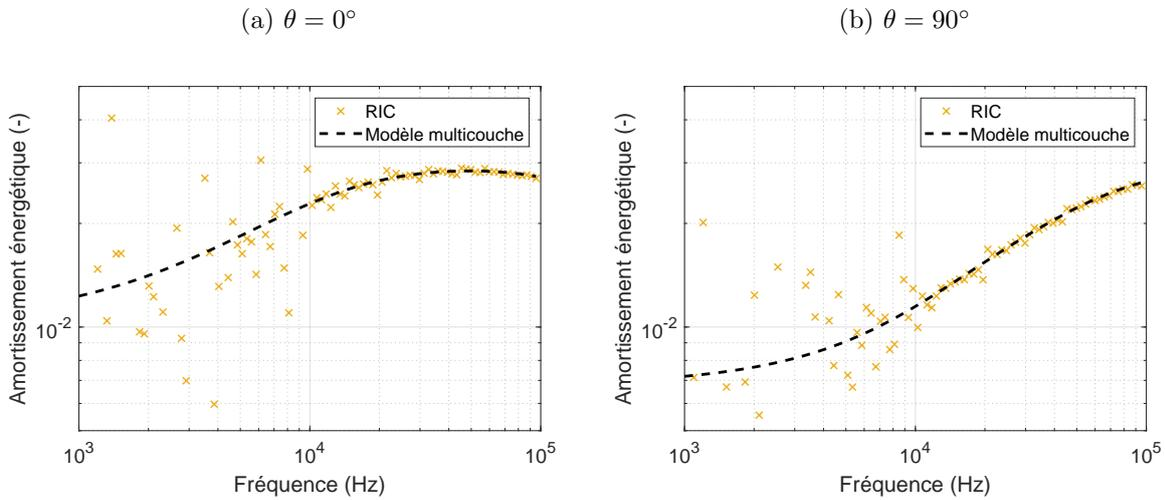
FIGURE 3.31 – Amortissement énergétique d’un sandwich orthotrope (caractéristiques des couches au Tableau 2.1, avec un empilement uniforme selon  $x$  et un amortissement de 3% sur le bois et 0.5% sur les couches de carbone) obtenu avec la formulation spatiale (Eq. (2.49)) dans les directions  $\theta = 0^\circ$  (a) et  $\theta = 90^\circ$  (b). RSB=30 dB. Estimations de RIC avec la régularisation de RIFF ( $\times$ ) et prédictions de notre modèle multicouche (—).
