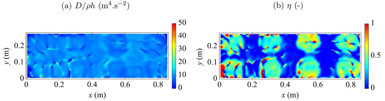
FIGURE 1.12 – Rigidité de flexion (a) et amortissement (b) d’une plaque composite en fibres de verre munie de patches élastomère identifiée par la méthode RIFF isotrope à  $f = 2$  kHz. Résultats issus des travaux de Ablitzer *et al.* [1].
