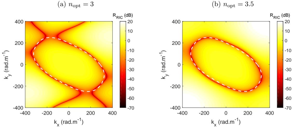
FIGURE 3.27 – Cartographie de  $\mathcal{R}_{\text{RIC}}$  obtenus à 10 kHz avec une régularisation définie par  $n_{\text{opt}} = 3$  (a) et  $n_{\text{opt}} = 3.5$  (b). RSB=30 dB. Nombre d'onde de flexion théorique (tirets blanc). Résultats obtenus à partir de la simulation d'une plaque anisotrope (paramètres matériaux au Tableau 3.1).
