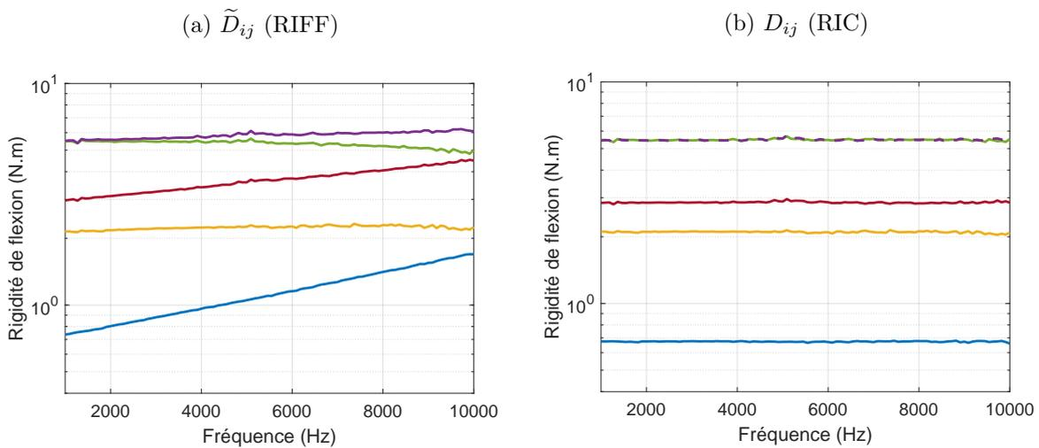
FIGURE 3.22 – Rigidités de flexion ( $D_{11}$  (—),  $D_{22}$  (—),  $D_{12}$  (—),  $D_{16}$  (—),  $D_{26}$  (—)), estimées par RIFF (a) et par RIC (b) avec l’approche itérative (30 itérations). Résultats obtenus à partir de la simulation d’une plaque anisotrope (paramètres matériaux au Tableau 3.1).
