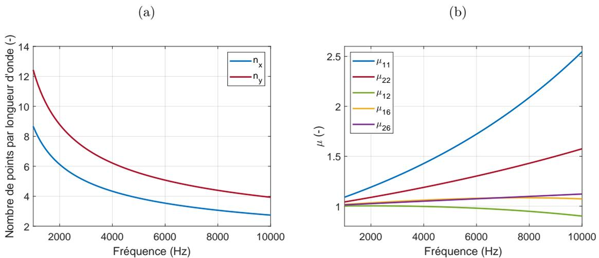
FIGURE 3.9 – Nombre de points par longueur d'onde ( $n_x, n_y$ ) (a) et coefficients correcteurs  $\mu$  estimés par RIC (b). Résultats obtenus à partir de la simulation d'une plaque anisotrope (paramètres matériaux au Tableau 3.1).
