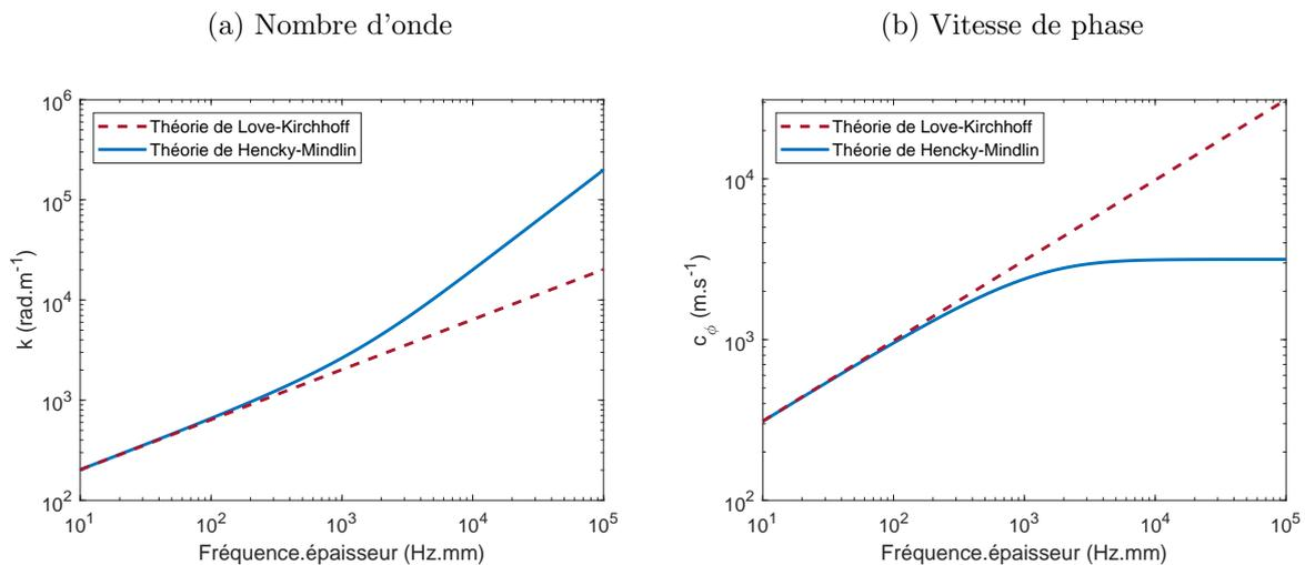
FIGURE 1.2 – Nombre d'onde (a) et vitesse de phase (b) propre au mode de flexion d'une plaque d'aluminium ( $E = 70$  GPa,  $\rho = 2700$  kg.m<sup>-3</sup>,  $\nu = 0.3$ ) en fonction du produit fréquence-épaisseur. Modélisation en plaque mince de Love-Kirchhoff (---) et en plaque épaisse de Hencky-Mindlin (—).
