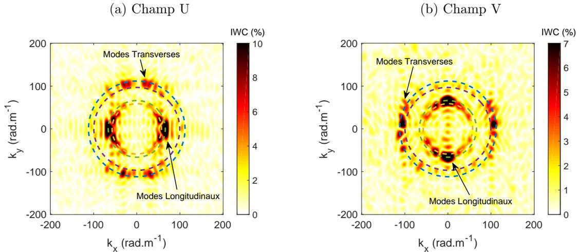
FIGURE 4.14 – Indice de corrélation de la méthode IWC appliqué aux champs de déplacement membranaire mesuré par le vibromètre 3D sur le sandwich nids d'abeille.  $f = 50$  kHz. Valeurs théoriques des courbes de dispersion calculées par notre modèle multicouche (Membrane (---), Membrane transverse (---), Cisaillement (-.-), Cisaillement transverse (-.-)).
