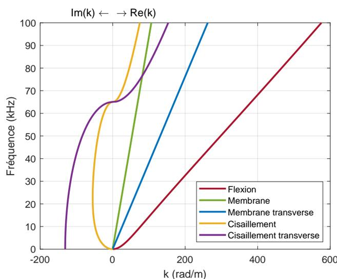
FIGURE 2.3 – Courbes de dispersion dans la direction  $x$  d'un sandwich anisotrope (caractéristiques des couches au Tableau 2.1). Flexion (—), Membrane (—), Membrane transverse (—), Cisaillement (—), Cisaillement transverse (—).
