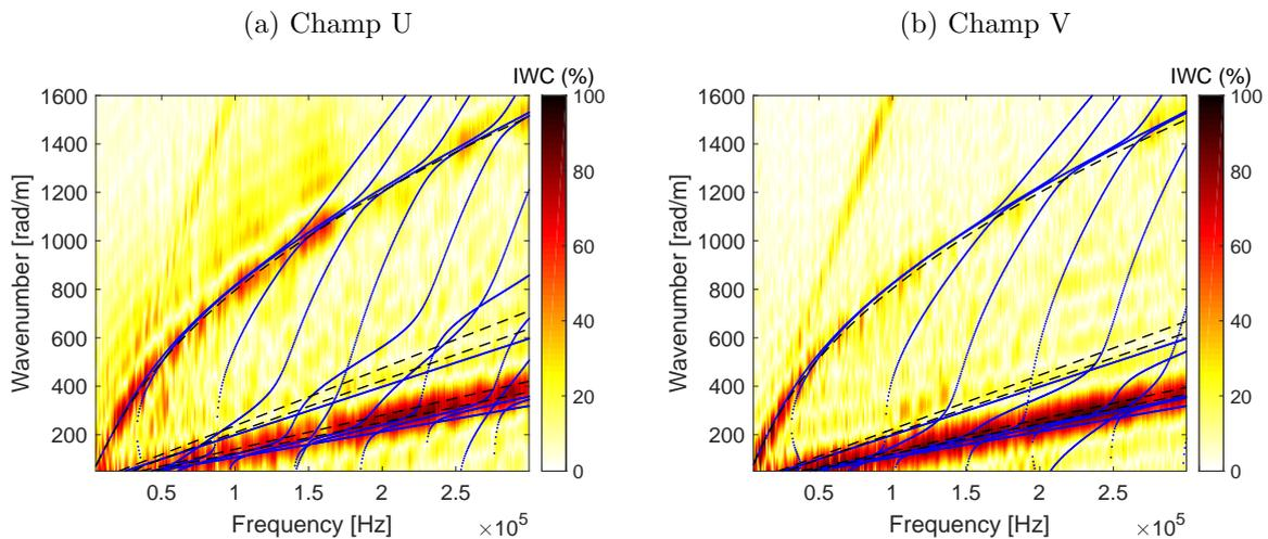
FIGURE 4.13 – Indice de corrélation de la méthode IWC appliqué aux champs de déplacement membranaire (U,V) respectivement mesuré dans les axes  $x$  (a) et  $y$  (b) avec le protocole B sur le sandwich nids d'abeille. Valeurs théoriques des courbes de dispersion calculées par le modèle des ondes de Lamb ( $\cdot$ ) et notre modèle multicouche ( $--$ ).
