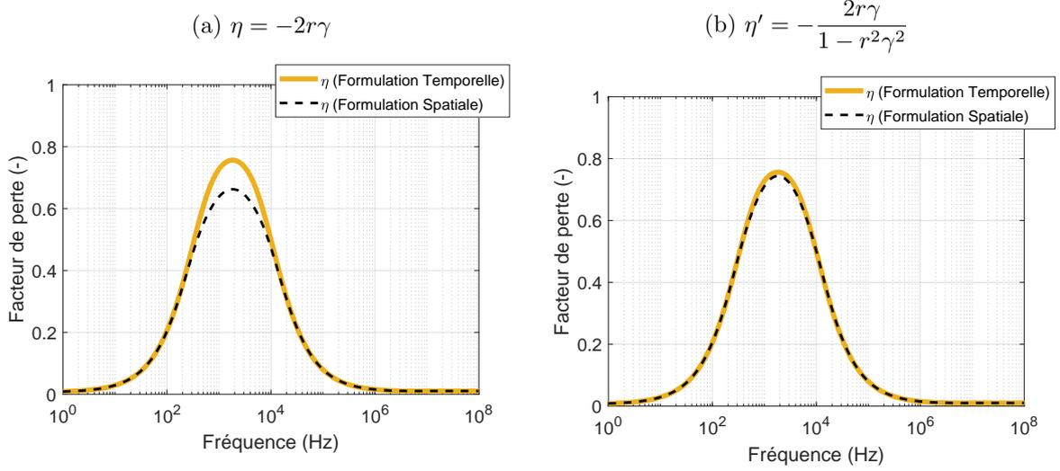
FIGURE 2.23 – Formulation spatiale (---) obtenue à partir de  $\eta = -2r\gamma$  (a) et de  $\eta' = -2r\gamma/(1 - r^2\gamma^2)$  (b) et temporelle (—) de l’amortissement énergétique du mode de flexion d’un sandwich isotrope (caractéristiques des couches au Tableau 2.2). Amortissement des peaux : 0.5%. Amortissement du cœur : 80%.
