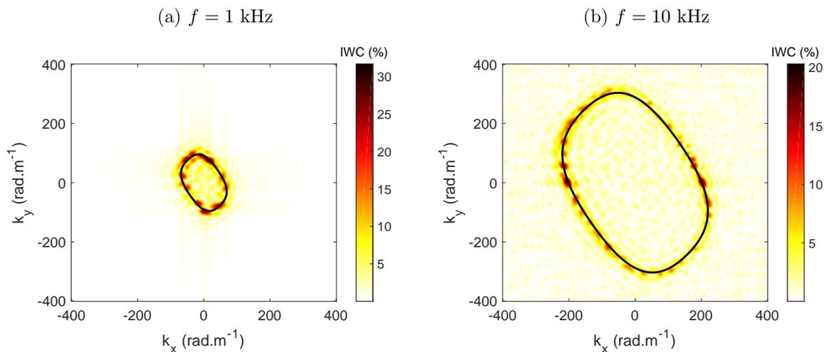
FIGURE 2.18 – Indices de corrélation obtenus par la méthode IWC sur la plaque composite d'empilement laminé dans le plan d'onde  $(k_x, k_y)$  pour  $f = 1$  (a) et 10 (b) kHz. Nombre d'onde flexion calculé par le modèle (—).
