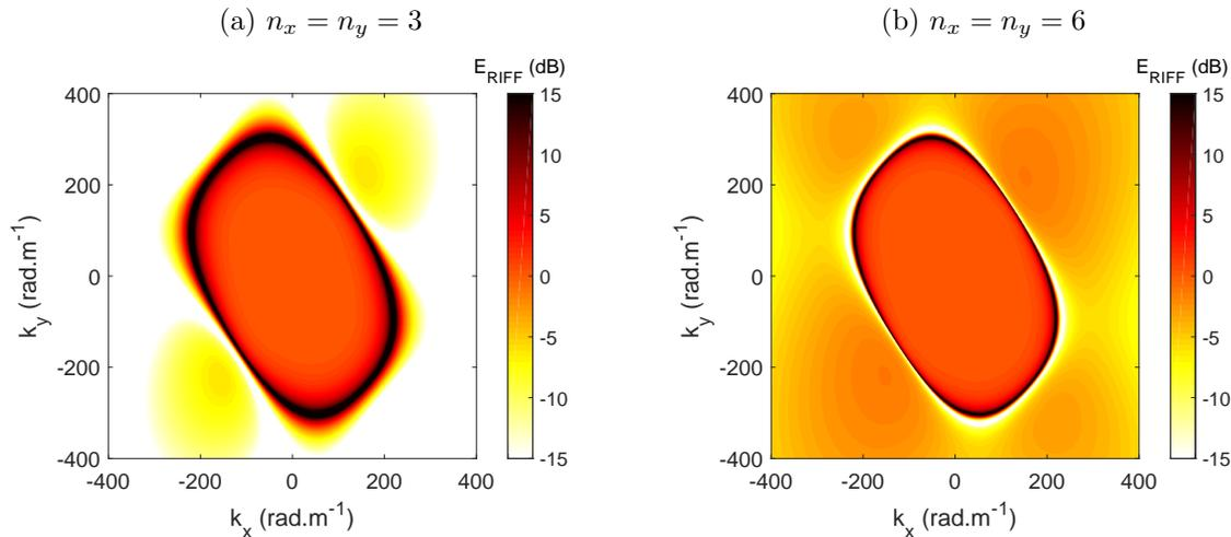
FIGURE 3.3 – Réponse de RIFF dans le domaine des nombres d'onde pour  $n_x = n_y = 3$  (a) et  $n_x = n_y = 6$  (b). Résultats obtenus à partir des caractéristiques de la plaque composite à empilement laminaire (caractéristiques des couches au Tableau 2.3) à 10 kHz.
