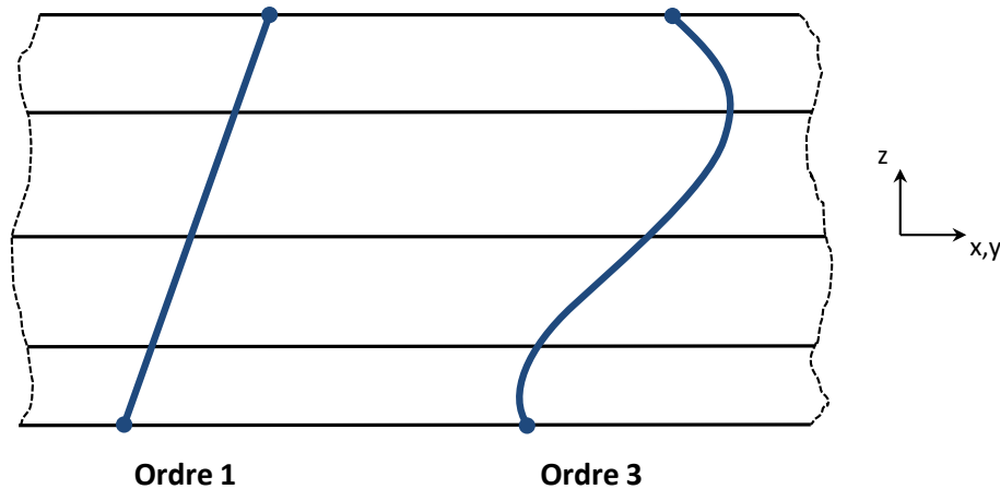
FIGURE 1.1 – Exemples de champs de déplacement d'ordre 1 et 3 postulés par les modèles monocouches équivalents pour un multicouche composé de 4 couches.
