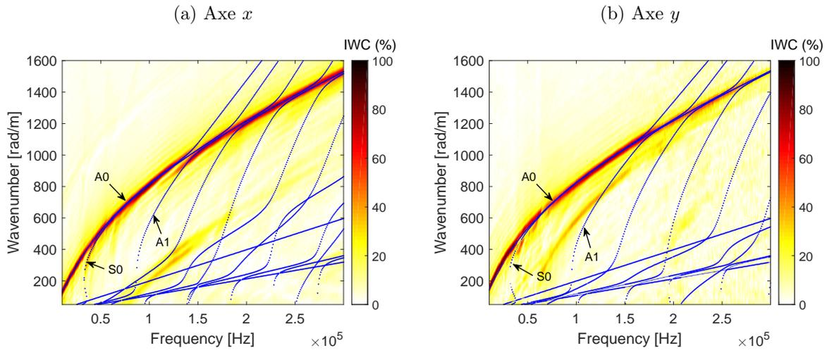
FIGURE 4.12 – Indice de corrélation de la méthode IWC appliqué aux champs de déplacement transverse mesuré dans les axes  $x$  (a) et  $y$  (b) sur le sandwich nids d'abeille. Valeurs théoriques des courbes de dispersion calculées par le modèle des ondes de Lamb ( $\cdot$ ).
