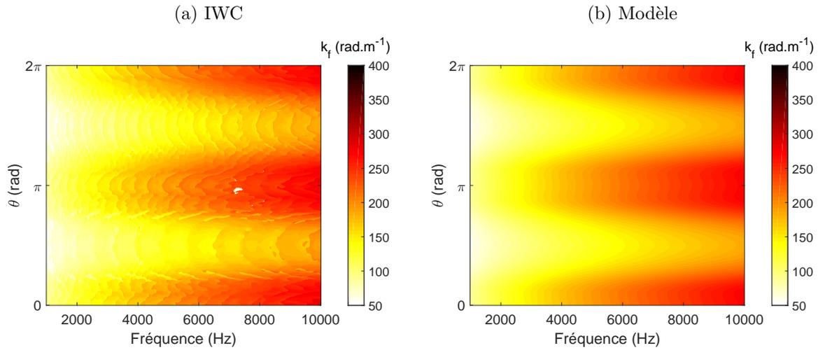
FIGURE 2.13 – Nombre d’onde naturel de flexion  $k_f$  de la plaque composite d’empilement croisé identifié expérimentalement avec la méthode IWC (a) et calculé analytiquement avec le modèle multicouche (b) en fonction de la fréquence et de la direction.
