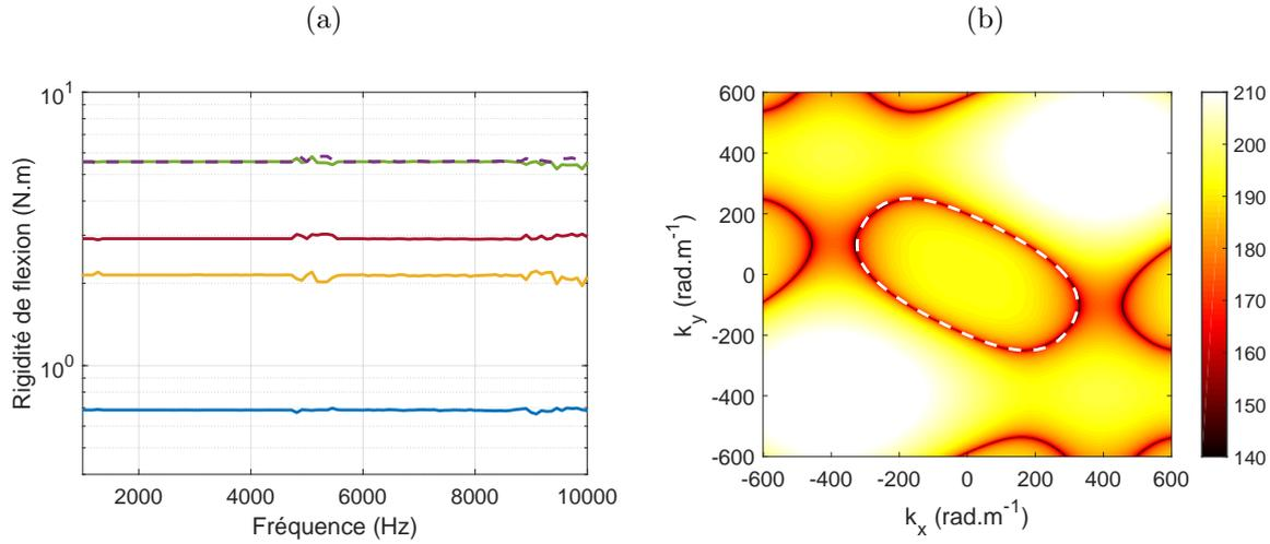
FIGURE 3.24 – Rigidités de flexion ( $D_{11}$  (—),  $D_{22}$  (—),  $D_{12}$  (—),  $D_{16}$  (—),  $D_{26}$  (—)), estimées par RIC avec l’approche par minimisation (a). Cartographie de  $\mathcal{R}_{\text{RIC}}$  à 10 kHz (b). Nombre d’onde de flexion théorique (tirets blanc). Résultats obtenus à partir de la simulation d’une plaque anisotrope (paramètres matériaux au Tableau 3.1).
