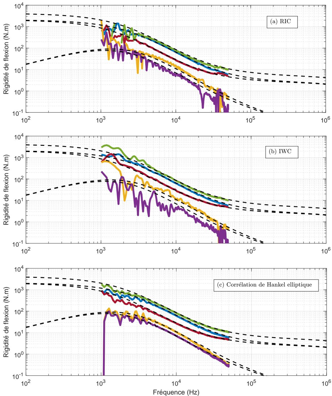
FIGURE 4.6 – Rigidités de flexion du sandwich nids d’abeille identifiées par RIC (a), IWC (b) et la corrélation de Hankel elliptique (c). ( $D_{11}$  (—),  $D_{22}$  (—),  $D_{12}$  (—),  $D_{16}$  (—),  $D_{26}$  (—)). Valeurs théoriques de notre modèle multicouche (—).
