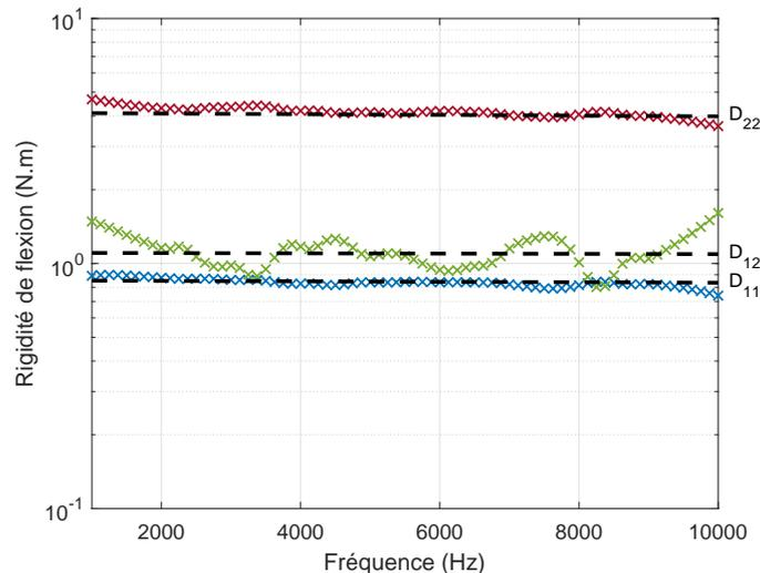
FIGURE 2.14 – Rigidités de flexion équivalentes de la plaque composite d’empilement croisé identifiées expérimentalement avec la méthode IWC ( $D_{11}$  ( $\times$ ),  $D_{22}$  ( $\times$ ),  $D_{12}$  ( $\times$ )). Valeurs théoriques du modèle multicouche (—).
