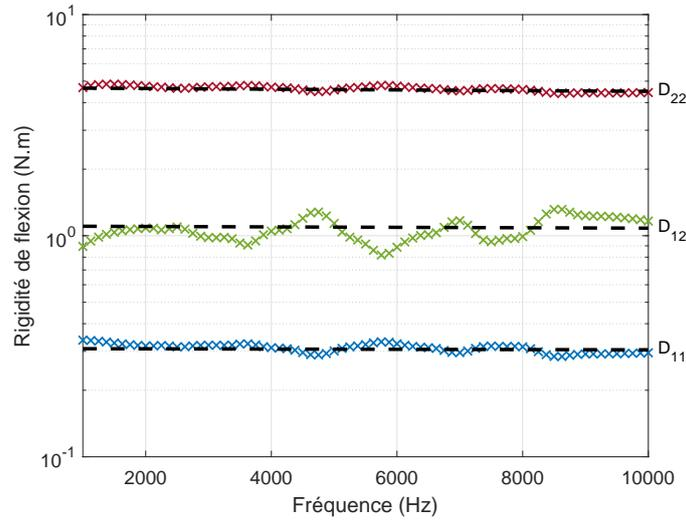
FIGURE 2.11 – Rigidités de flexion équivalentes de la plaque composite d'empilement uniforme identifiées expérimentalement avec la méthode IWC ( $D_{11}$  ( $\times$ ),  $D_{22}$  ( $\times$ ),  $D_{12}$  ( $\times$ )). Valeurs théoriques du modèle multicouche (—).
