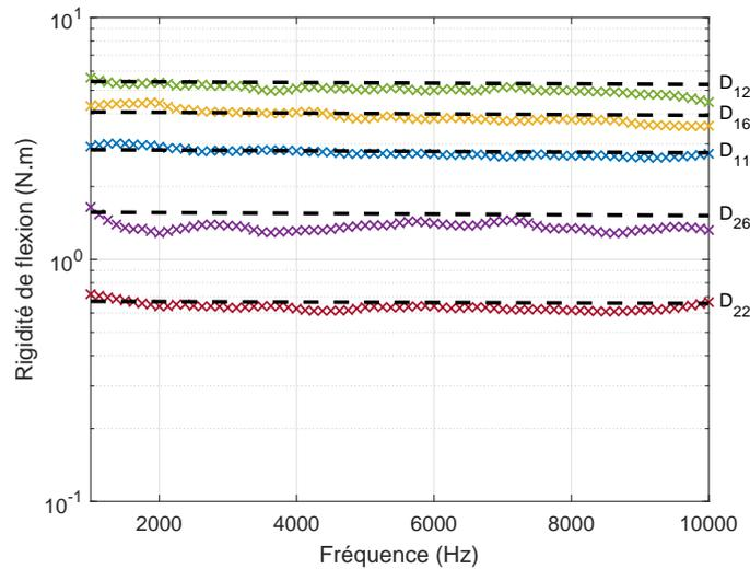
FIGURE 2.17 – Rigidités de flexion équivalentes de la plaque composite d'empilement laminé identifiées expérimentalement avec la méthode IWC ( $D_{11}$  ( $\times$ ),  $D_{22}$  ( $\times$ ),  $D_{12}$  ( $\times$ ),  $D_{16}$  ( $\times$ ),  $D_{26}$  ( $\times$ )). Valeurs théoriques du modèle multicouche (—).
