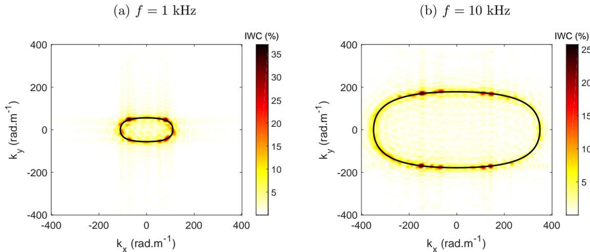
FIGURE 2.12 – Indices de corrélation obtenus par la méthode IWC sur la plaque composite d’empilement uniforme dans le plan d’onde  $(k_x, k_y)$  pour  $f = 1$  (a) et 10 (b) kHz. Nombre d’onde flexion calculé par le modèle (—).
