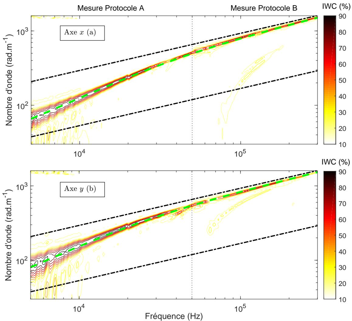
FIGURE 4.11 – Indice de corrélation de la méthode IWC dans les axes  $x$  (a) et  $y$  (b) représenté sous la forme de contour. Valeurs théoriques du nombre d'onde de flexion calculé par le modèle multicouche (---). Valeurs asymptotiques basses et hautes fréquences (---).
