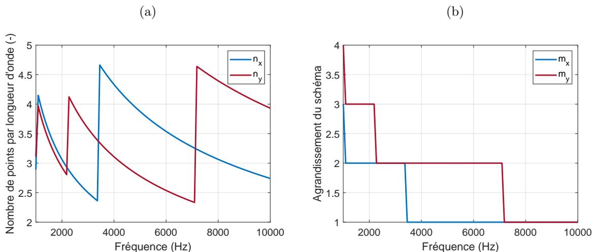
FIGURE 3.15 – Nombre de points par longueur d'onde  $(n_x, n_y)$  (a) et agrandissement  $(m_x, m_y)$  (b) du schéma de RIC dans le cas d'un champ de déplacement bruité (RSB=30 dB). Résultats obtenus à partir de la simulation d'une plaque anisotrope (paramètres matériaux au Tableau 3.1).
