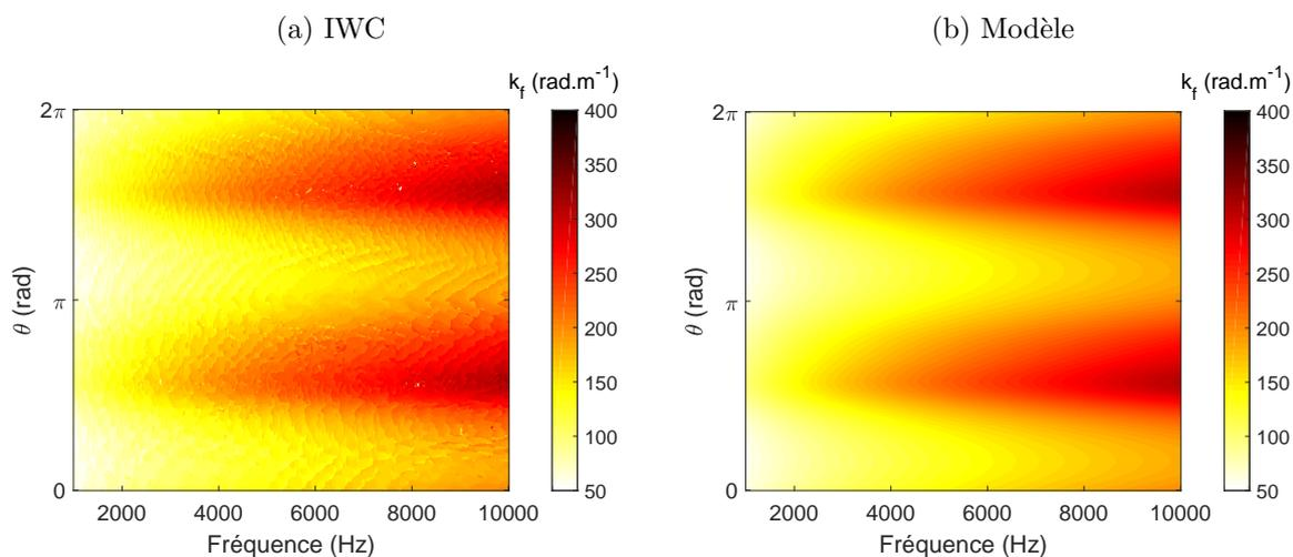
FIGURE 2.16 – Nombre d’onde naturel de flexion  $k_f$  de la plaque composite d’empilement laminé identifié expérimentalement avec la méthode IWC (a) et calculé analytiquement avec le modèle multicouche (b) en fonction de la fréquence et de la direction.
