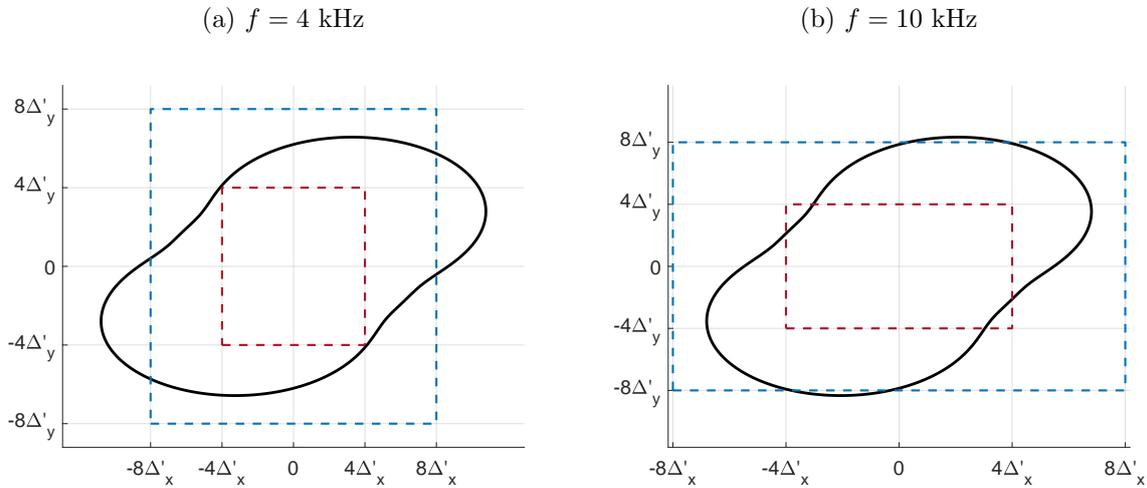
FIGURE 3.16 – Longueur d'onde de flexion (—) d'une plaque anisotrope (paramètres matériaux au Tableau 3.1) à 4 kHz (a) et à 10 kHz (b). Le rectangle rouge représente la limite inférieure de  $(n_x, n_y)$  correspondant au critère de Shannon. Le rectangle bleu représente la limite supérieure de  $(n_x, n_y)$ .
