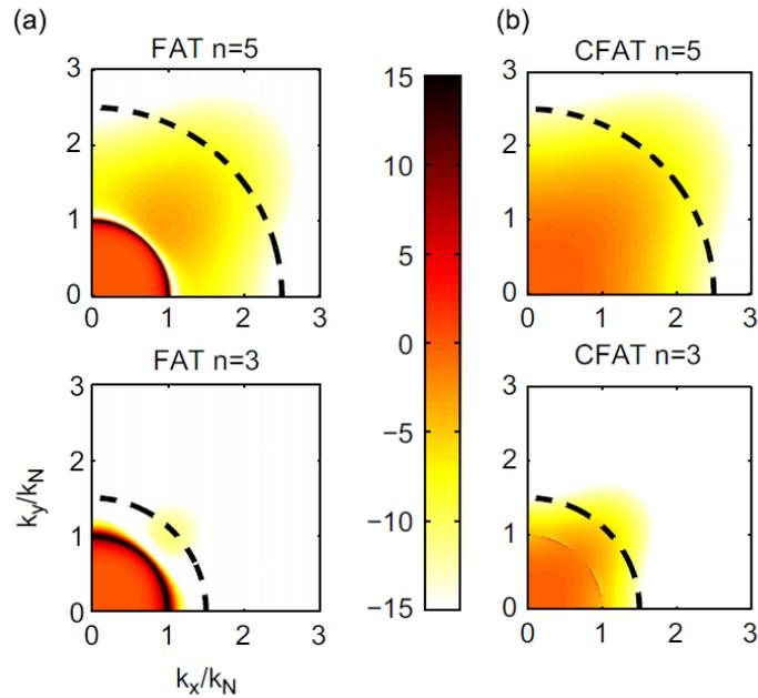
FIGURE 1.15 – Réponse de RIFF (a) et RIC (b) dans l’espace des nombres d’onde pour  $n = 5$  (haut) et  $n = 3$  (bas).  $k_N$  est le nombre d’onde de flexion. Résultats issus des travaux de Leclère et Pézerat [58].
