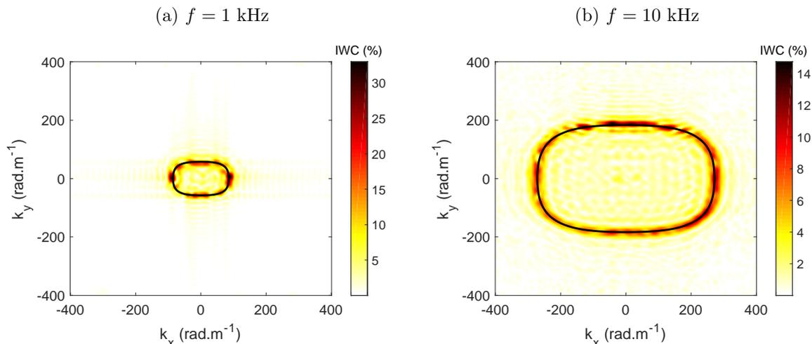
FIGURE 2.15 – Indices de corrélation obtenus par la méthode IWC sur la plaque composite d’empilement croisé dans le plan d’onde  $(k_x, k_y)$  pour  $f = 1$  (a) et 10 (b) kHz. Nombre d’onde flexion calculé par le modèle (—).
