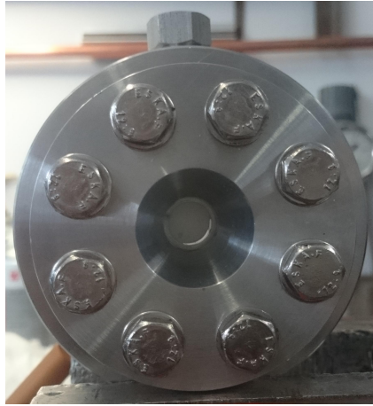
FIGURE 12.2 – La cellule à fenêtre de saphire dont le diamètre visible est de 10 mm à titre d'échelle. Au centre la suspension est légèrement jaune, en haut le connecteur pour la pompe.
