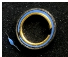
FIGURE B.7 – Joint d'origine du capteur XPM6 après défaillance par extrusion de l'élastomère (bleu), on voit les deux bagues de renfort.
