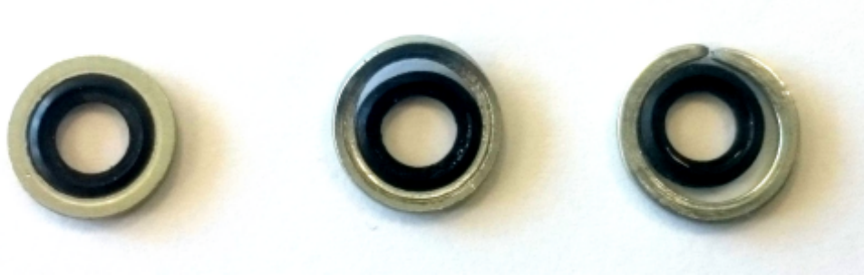
FIGURE B.8 – Joint élastomère doté d'une bague de renfort : neuf, déformé, rompu. La tenue en pression est obtenue grâce à un renfort en acier ajusté à la bague.
