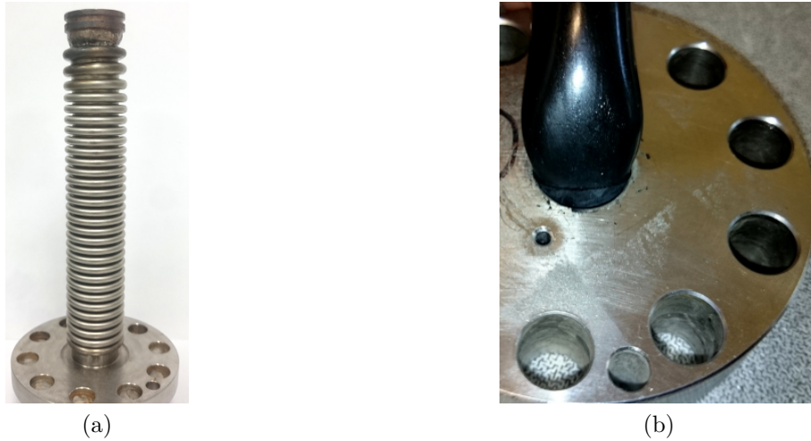
FIGURE 2.2 – (a) Soufflet métallique sollicité au delà de son seuil de pression maximale de 60 MPa. (b) Soufflet élastomère, le piston est plié pour révéler la rupture de l’adhésion à sa base.
