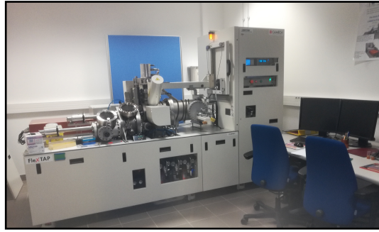
FIGURE 2.2 – Sonde atomique tomographique FlexTAP de CAMECA installée à la plateforme de nanocaractérisation (PFNC).
