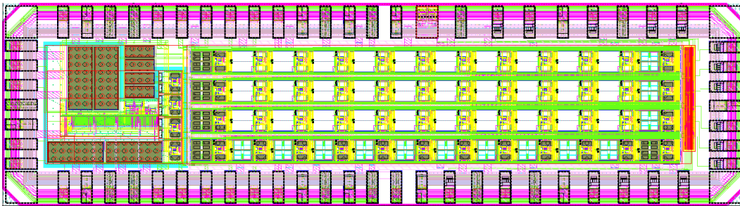
Figure 4.16: Schéma d'ensemble de FATALIC [106]. On distingue le bloc analogique à gauche et les quatre ADCs à douze étages.
