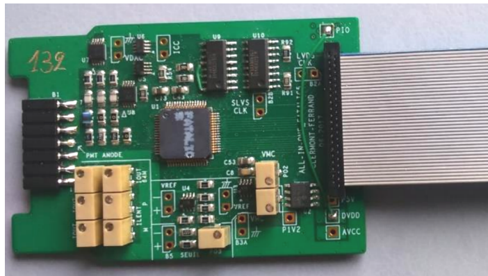
Figure 4.18: Photographie de la carte de lecture sur laquelle le circuit FATALIC est placé.
