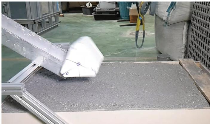
FIGURE 3.13 – Capture d’écran d’un enregistrement vidéo pour un essai réalisé avec un bloc triangulaire. Les repères sont difficilement visibles, ce qui pousse l’opérateur à réaliser la procédure de pointage à la souris de manière approximative.
