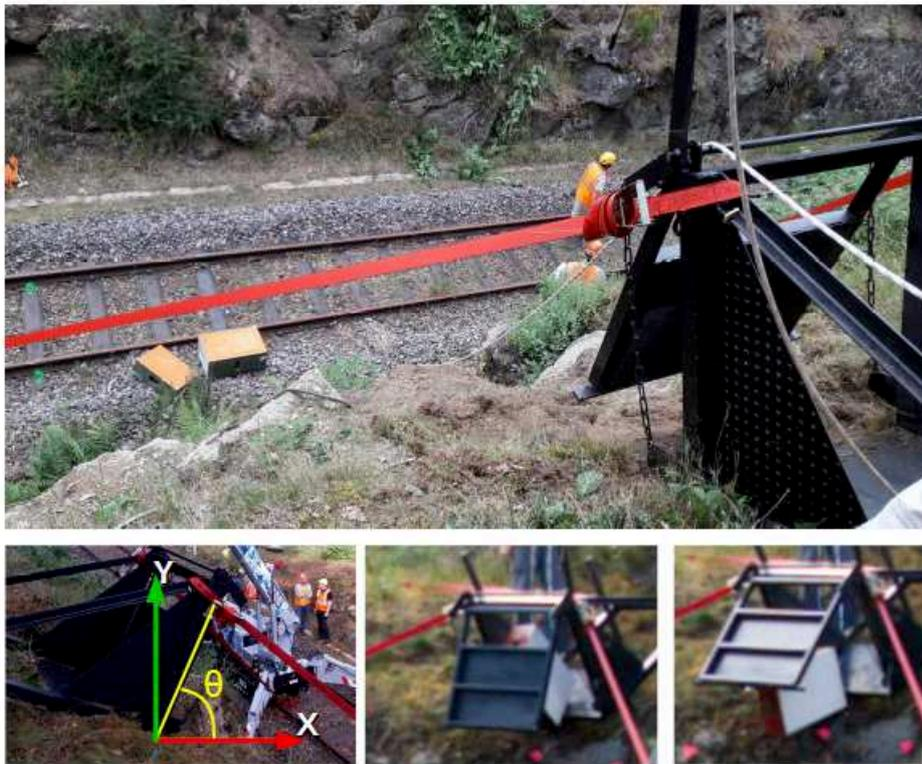
FIGURE 4.4 – Dispositif de lancement utilisé pendant les essais expérimentaux. Les blocs sont en contact avec la porte métallique qui s’ouvre mécaniquement sous le poids des blocs. L’angle d’inclinaison initiale des blocs par rapport au plan horizontal ( $\theta$ ) est de 60 degrés.
