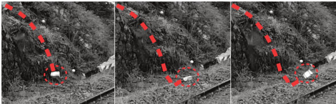
FIGURE 4.8 – Exemple de capture vidéo utilisée lors de l’optimisation des paramètres de contact entre le bloc et le ballast.
