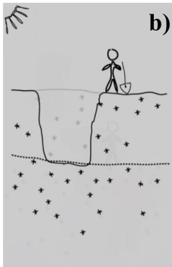
Figure 4 : Schéma illustrant le principe de mesure des variations de surface aux balises.
