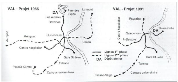
Figure 6 - Plans proposé en 1986 et 1991 du métro VAL à Bordeaux, extrait de l'ouvrage de L'HOST, Hervé, TRECOLLE, Guy et VERGER, Richard, Histoire des tramways, omnibus, trolleybus et autobus à Bordeaux, Bordeaux, éditions du Cabri, 2000
