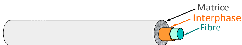
Figure II.1 Schéma représentatif d'un microcomposite [Jacques 00]
