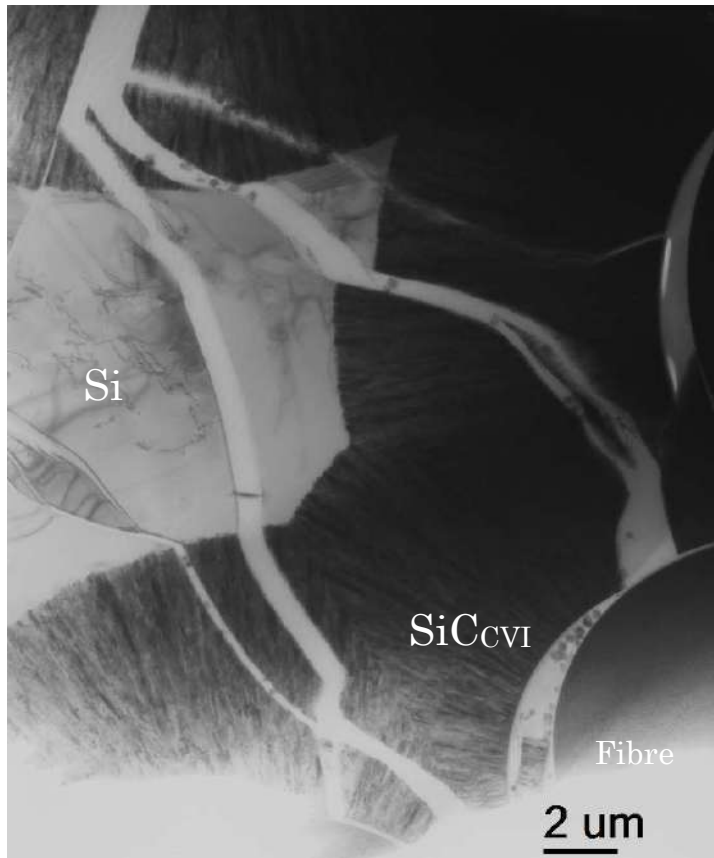
Figure V.17 Image MET présentant de nombreuses zones fissurées observables au sein d'un composite avec une interphase de 200 nm d'épaisseur et élaborée à 900°C
