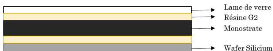
Figure III.2 Schéma d'une coupe transverse d'un matériau "sandwich" pour la MET
