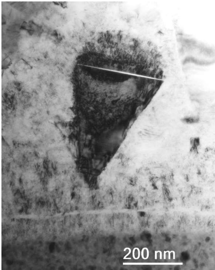
Figure III.35 Image FCC d'un monocristal entouré de BN plus ou moins organisé développé dans une interphase BN1200 déposée sous N 2
