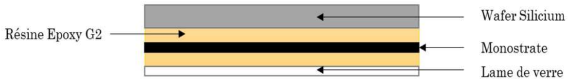
Figure II.37 Schéma explicatif du collage sandwich réalisé pour les essais de push-out
