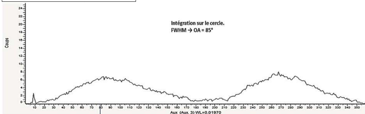
Figure III.15 Exemples de détermination de l'angle d'ouverture azimutale (OA) par intégration de l'intensité le long de l'anneau de première diffraction des plans hexagonaux à partir de la largeur à mi-hauteur du pic (FWHM) associé à l'arc de diffraction pour un BN fortement et faiblement cristallisé
