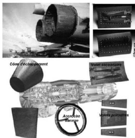
Figure 2 Exemples de pièces en composites à matrice céramique à base de SiC (renfort fibreux carboné ou SiC) pour applications aéronautiques au niveau des turboréacteurs (domaine militaire principalement) [Christin 02; Christin 05]
