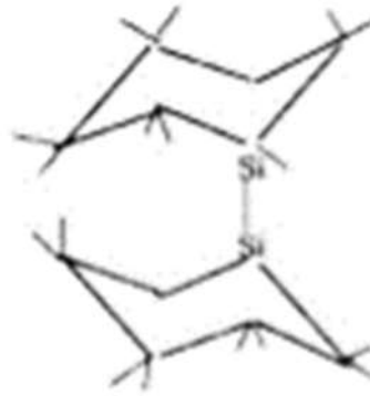
Figure I.2 Structure chimique des fibres de seconde génération après réticulation par irradiation [Bunsell 06]
