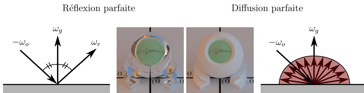
FIGURE 2.7 – Les modèles de BRDFs idéaux sont la réflexion parfaite (gauche) et la diffusion parfaite (droite).
