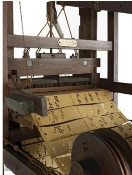
(b) Machine Jacquard à 400 crochets (1801)
