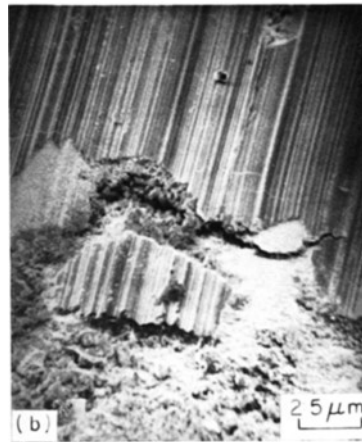
FIGURE 1.19 – Image MEB de la glaze layer formée sur un contact N75/C263 (base nickel) frotté à 800°C pendant 42 h [66]
