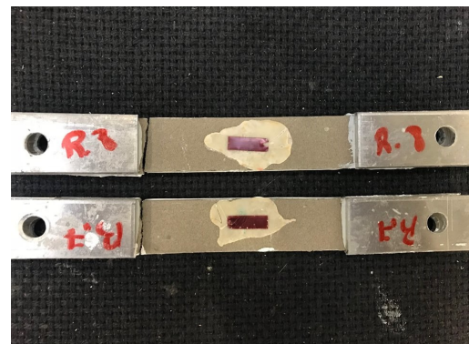
Figure 2.34 – Réponse en traction directe des éprouvettes parallélépipédiques de K3
