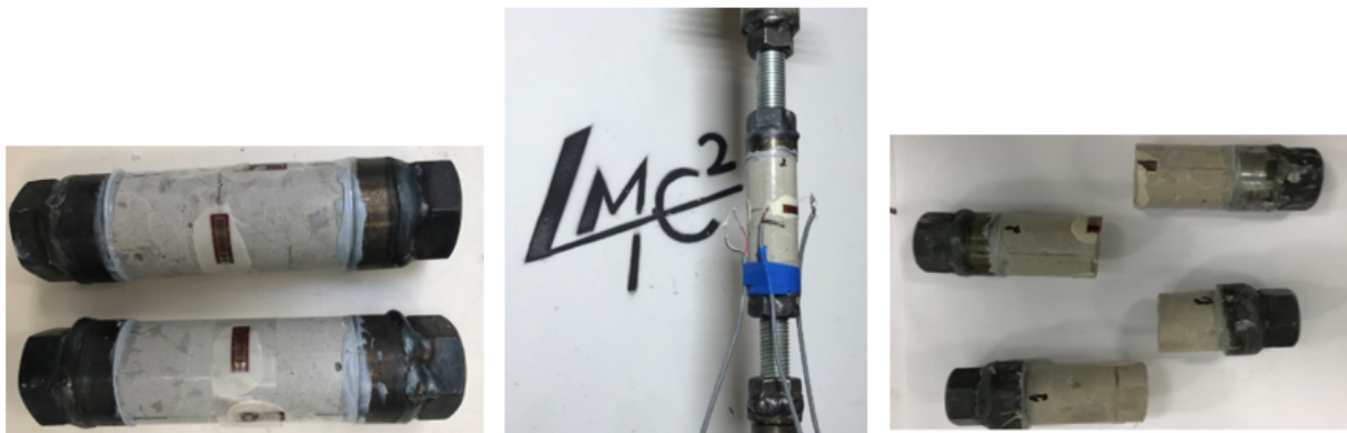
Figure 2.28 – Eprouvettes de traction cylindriques avant et après la rupture
