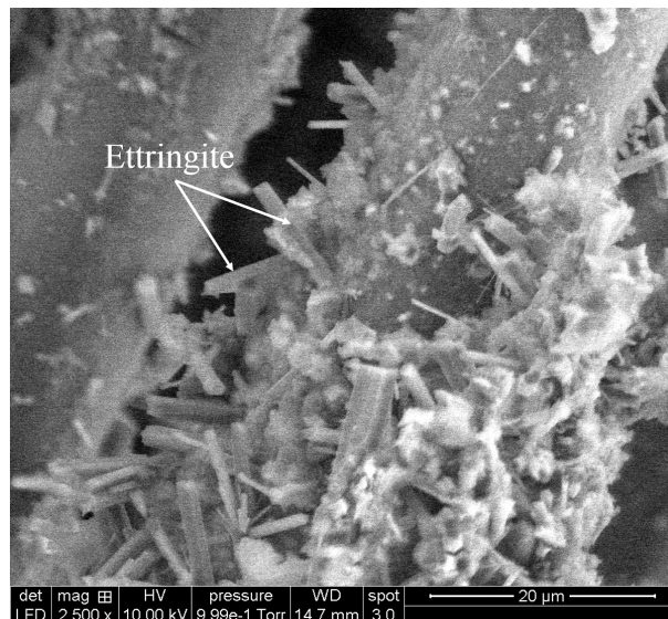
Figure 4.11 – Observations au MEB d'un filament interne du composite 3F.PS.CSA montrant l'hydratation de la poutre de pré-impregnation par voie sèche ( \times 2500 )
