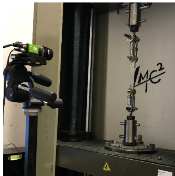
Figure 5.3 – Protocole expérimental de l'essai de traction du TRC
