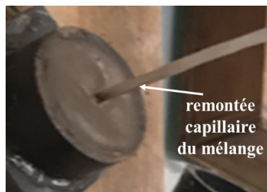
Figure 3.17 – Problème de mise en œuvre des éprouvettes Le2.PS
