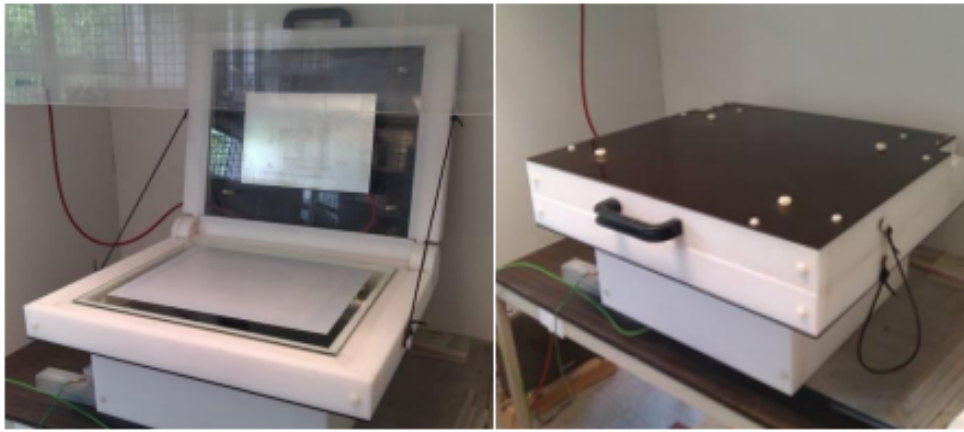
Figure 3.8 – Machine à l'échelle laboratoire utilisée pour imprégner à sec les fils de verre
