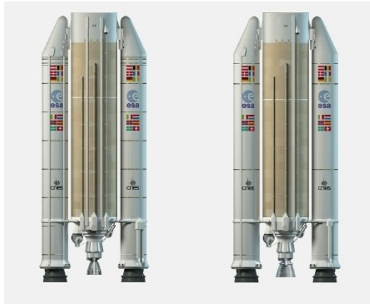
FIGURE 2 – Représentation de la partie basse d’Ariane 5, avec les deux EAP et l’EPC. Source : CNES.
