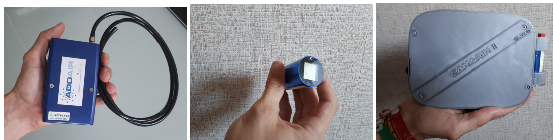
FIGURE II.16 – Trois capteurs utilisés : l’AE51, le Cairclip et le Canarin.
