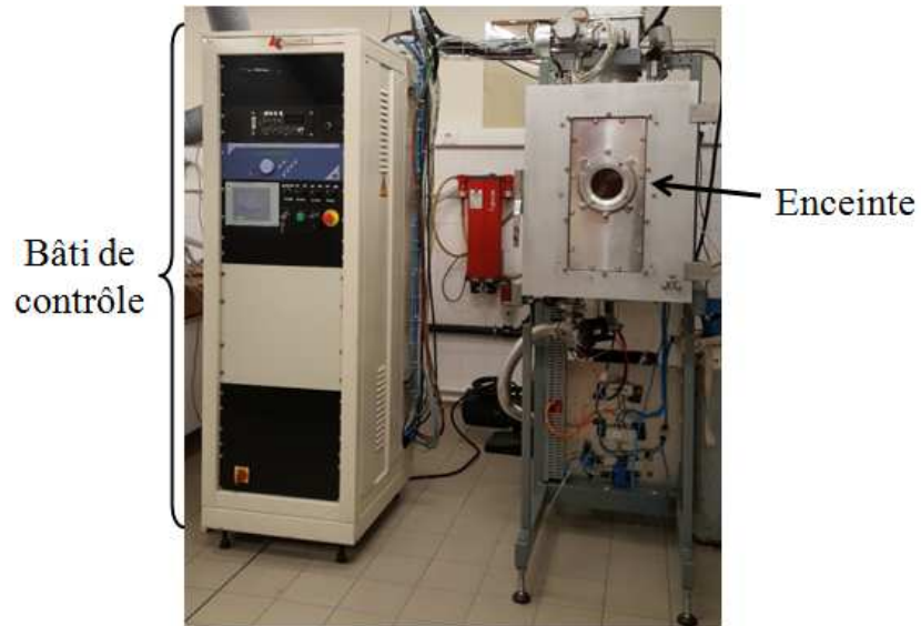
Figure 2. Représentation du réacteur plasma EVA 450 (Alliance concept)
