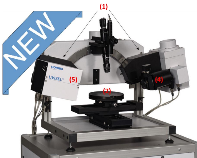
Figure II.14 : ellipsomètre de marque HORIBA-Jobin Yvon UVISEL.
