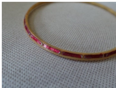
Figure II.21 - Photographie d'une couronne d'aimant externe.
