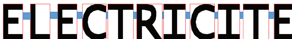
FIGURE 4.16 – Visualisation des boîtes englobantes des lettres (rouge) et de l'espace entre les boîtes (bleu)
