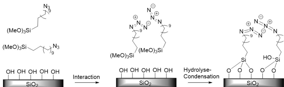
**Figure 62.** Processus envisagé du greffage du 11-azidoundécyltriméthoxysilane
