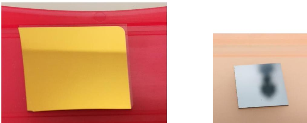
**Figure 58.** Substrat pour analyse PM-IRRAS (gauche) et wafer de silicium pour AFM (droite)
