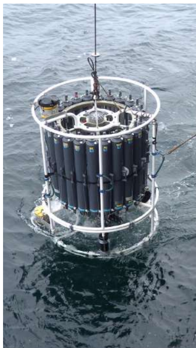
FIGURE 4.3 – Bouteilles Niskin sur une rosette lors de la campagne GEOVIDE.
