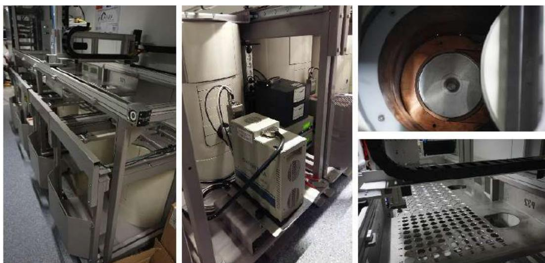
FIGURE 4.12 – Spectromètres bas bruit en fonctionnement au LAFARA. Le passeur innovant est visible sur la photo de gauche. Les cinq spectromètres sont refroidis par cryogénérateur électrique CP5+.
