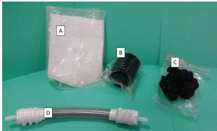
FIGURE 4.1 – Filtre à particules (A), cartouche Mn (B), fibre Mn (C) et cartouche PVC contenant une fibre Mn(D) pour la filtration de petit volume d'eau (à partir de 10L) pour l'analyse du  $^{226}\text{Ra}$ .
