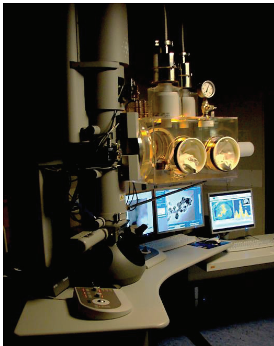
Figure 46 Photo du MET du JRC-Karlsruhe. Il a été adapté à l'étude des matériaux nucléaires par l'ajout d'une boîte-à-gants. Un dispositif DTPE® de La Calhène est utilisé pour transférer les échantillons vers le microscope.
